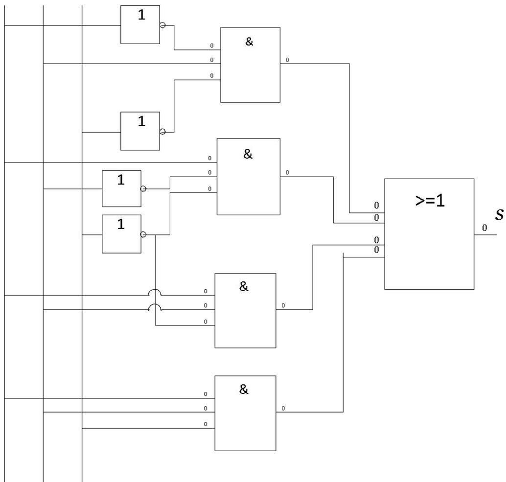
Пример синтеза преобразователя кода Грея в арифметический двоичный код.
