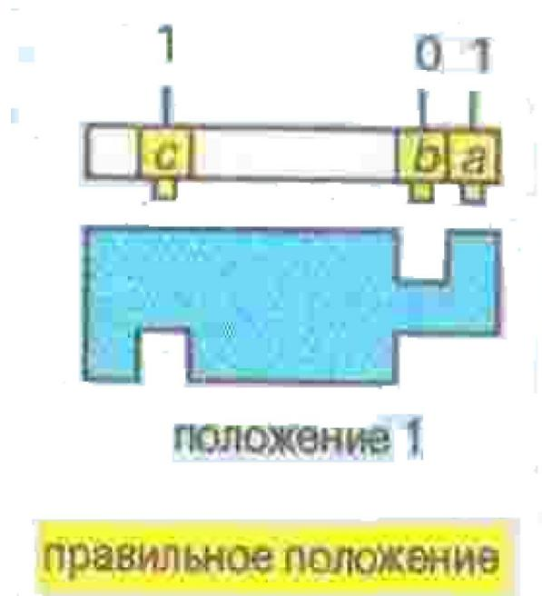
Если заготовки подаются в положениях 2, 3, или 4, они будут автоматически поворачиваться до достижения правильного положения 1.
