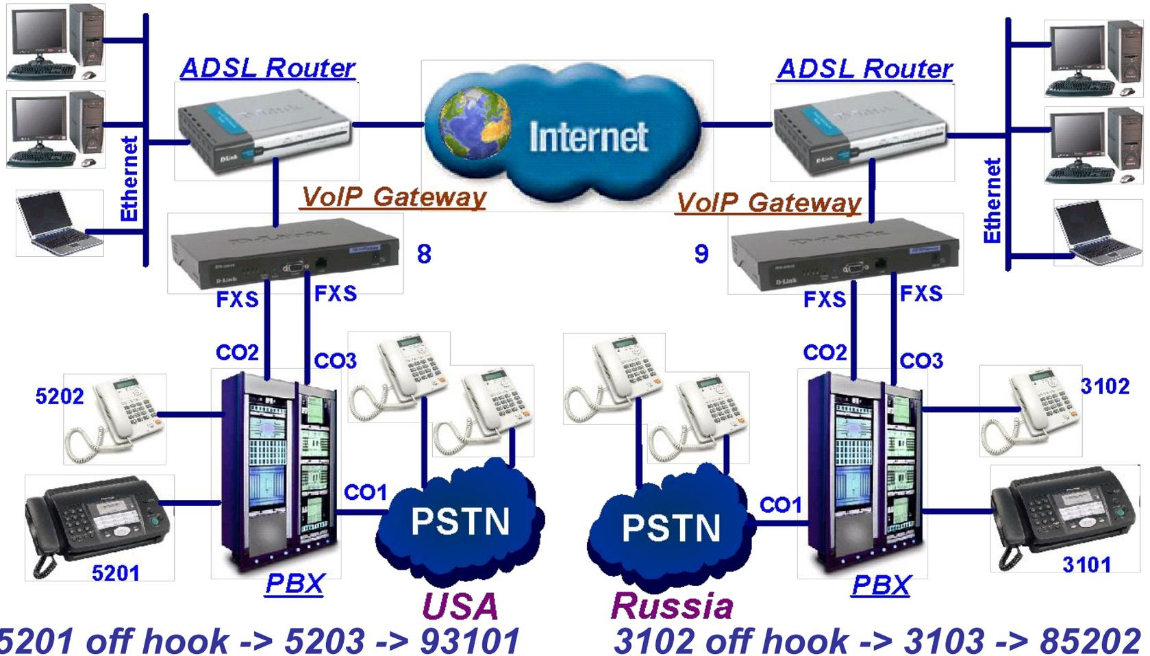
*Использование голосовых шлюзов для выноса номеров внутриофисной АТС в удалённый офис через оптический канал*
