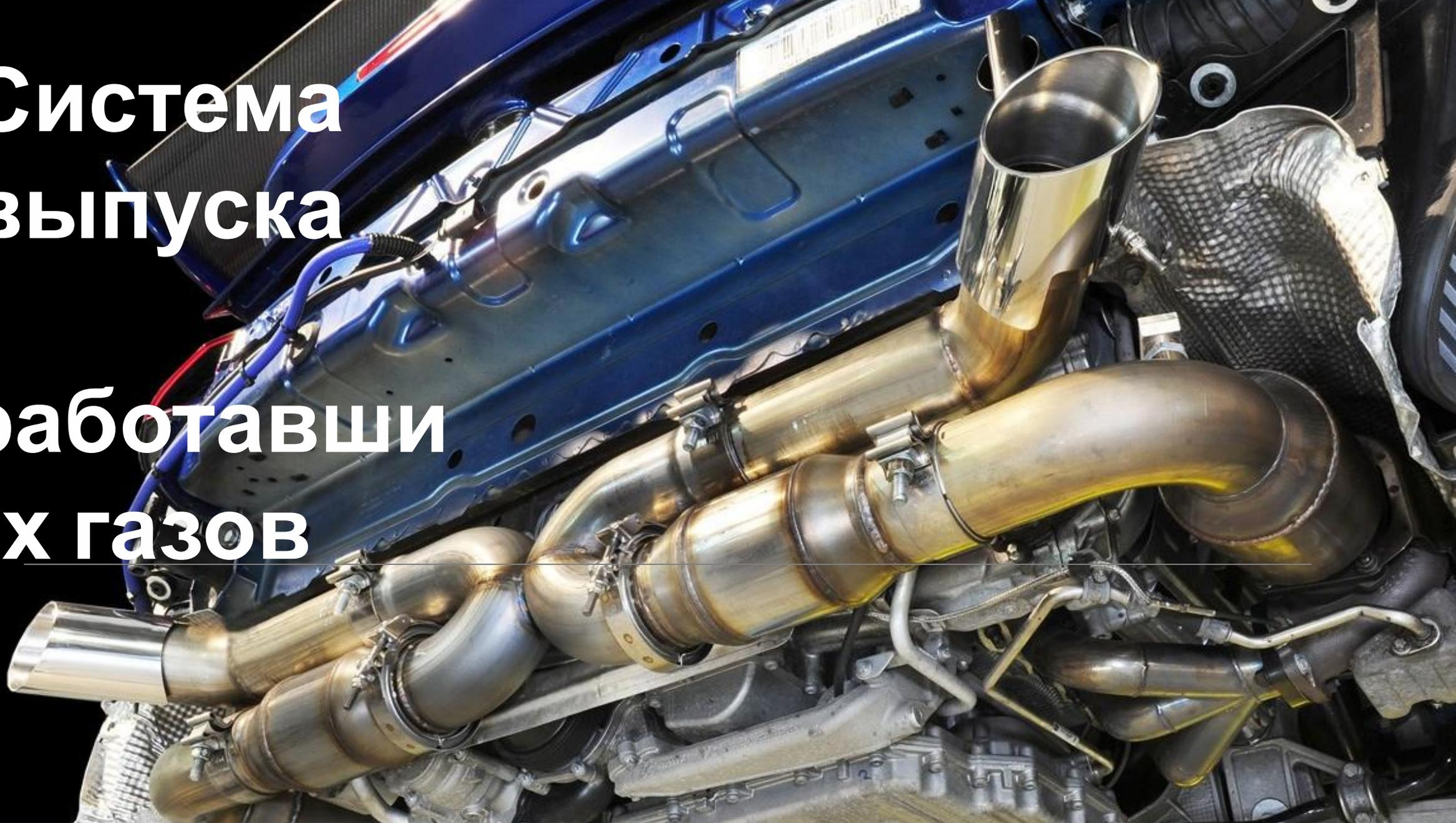
Выпускная система (другое наименование - система выпуска отработавших газов, выхлопная система) предназначена для отвода отработавших газов из цилиндров двигателя, их охлаждения, а также снижения шума и токсичности.
