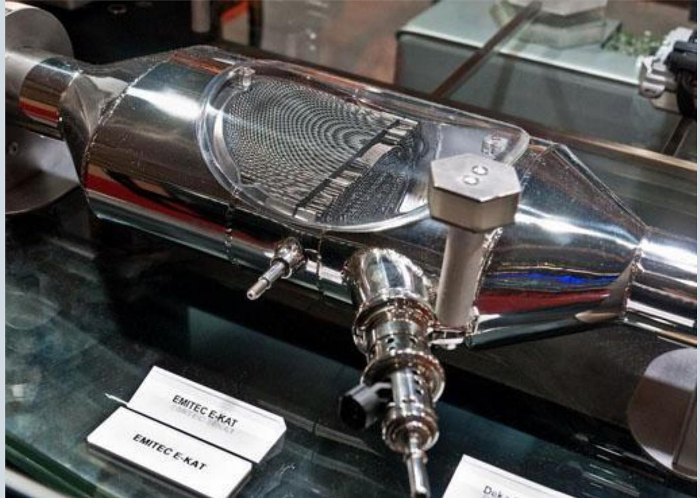
На дизельных двигателях применяется сажевый фильтр, который обеспечивает снижение выброса сажи в атмосферу с отработавшими газами. В выпускной системе сажевый фильтр может быть объединен с каталитическим нейтрализатором.
