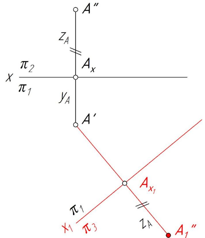
*Построение профильной проекции точки (фигуры) есть также использование способа замены плоскостей проекций (рис. 40)*
