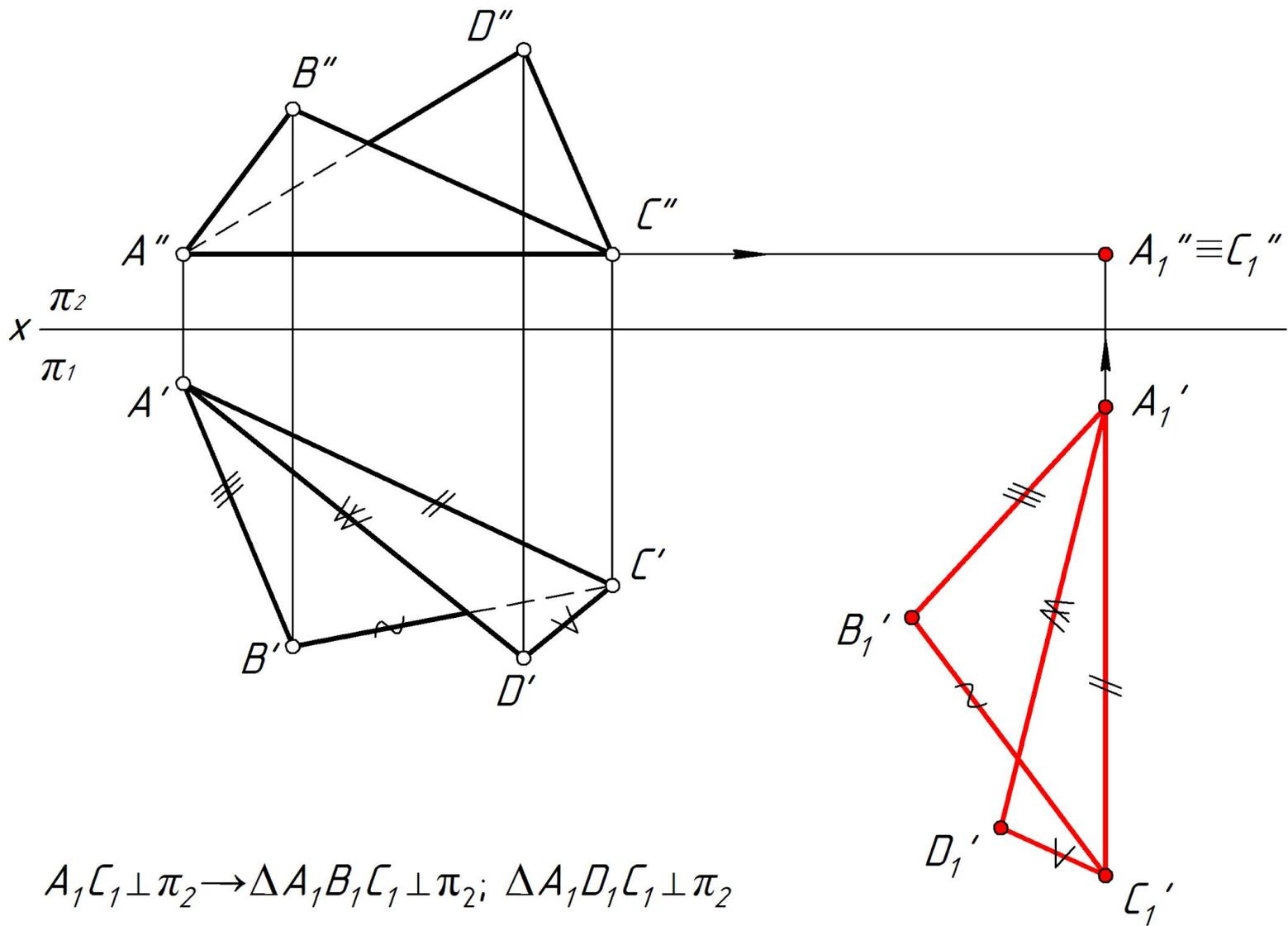
Задача. Определить угол между плоскостями  $\triangle ABC$  и  $\triangle ADC$ .
