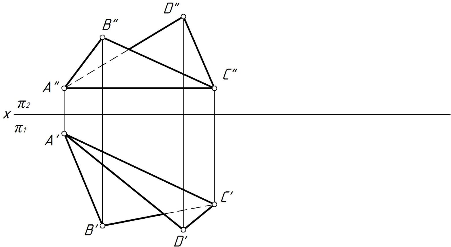
Задача. Определить угол между плоскостями  $\triangle ABC$  и  $\triangle ADC$ .
