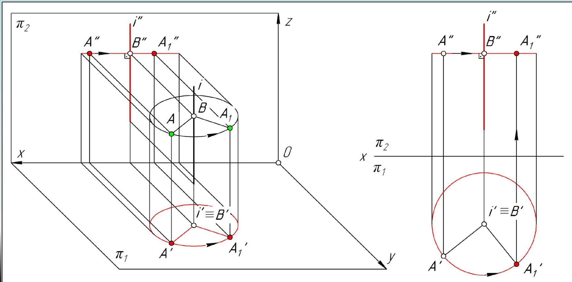
Задача. Определить длину отрезка вращением вокруг проецирующей прямой.
