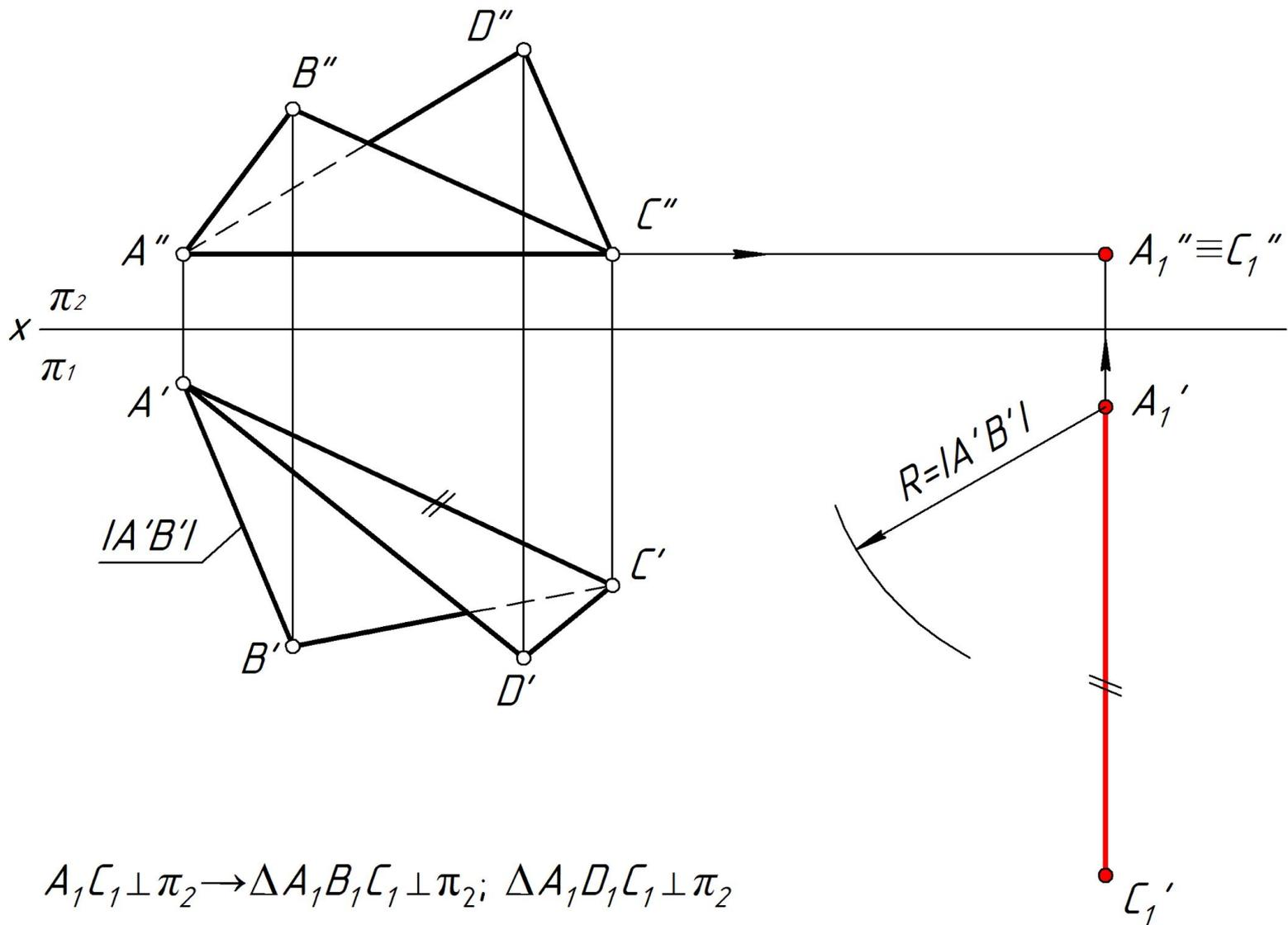
Задача. Определить угол между плоскостями  $\Delta ABC$  и  $\Delta ADC$ .
