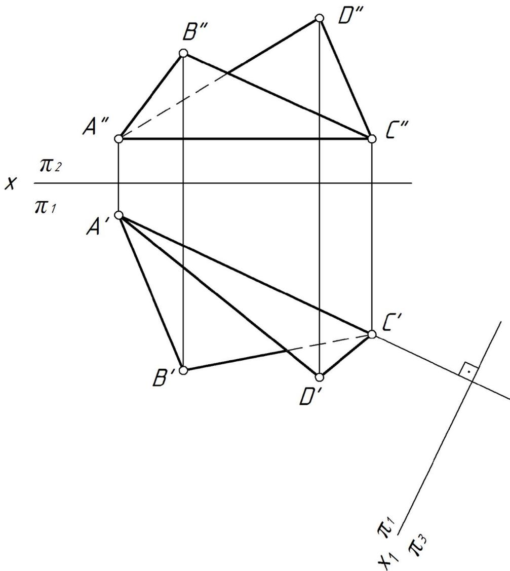
Задача. Определить угол между плоскостями  $\triangle ABC$  и  $\triangle ADC$ .
