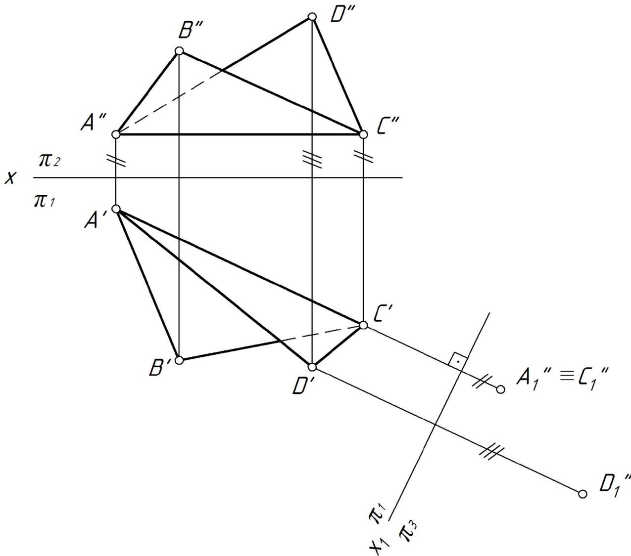
Задача. Определить угол между плоскостями  $\triangle ABC$  и  $\triangle ADC$ .
