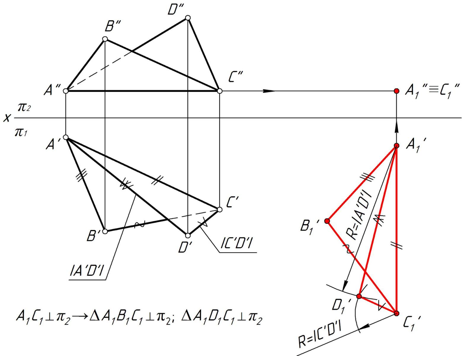
Задача. Определить угол между плоскостями  $\triangle ABC$  и  $\triangle ADC$ .
