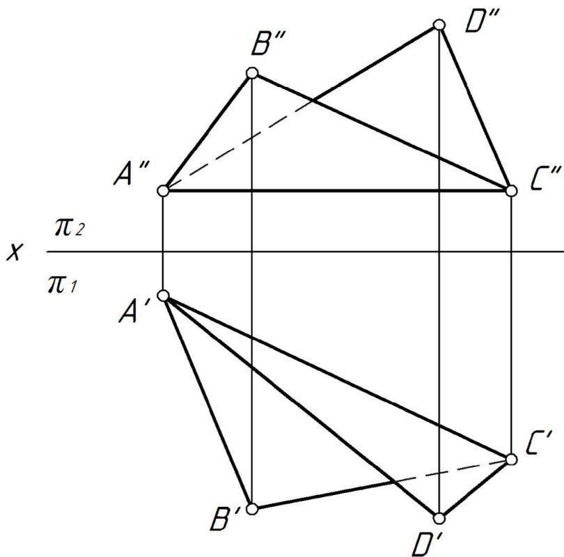
Задача. Определить угол между плоскостями  $\triangle ABC$  и  $\triangle ADC$ .
