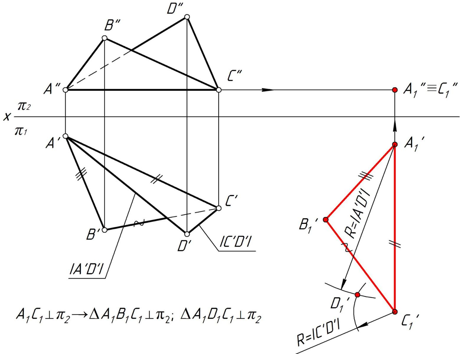
Задача. Определить угол между плоскостями  $\Delta ABC$  и  $\Delta ADC$ .
