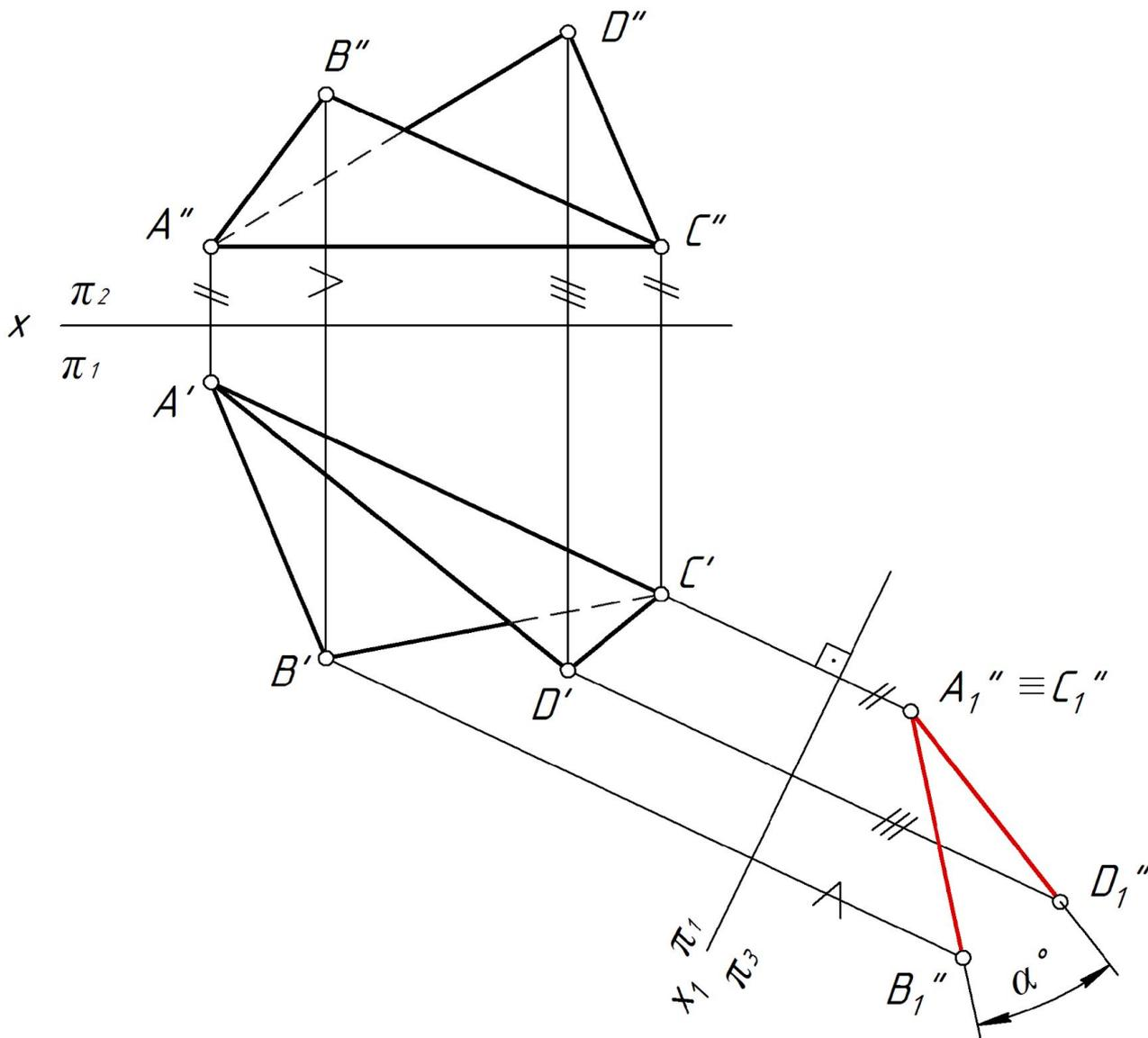
Задача. Определить угол между плоскостями  $\triangle ABC$  и  $\triangle ADC$ .
