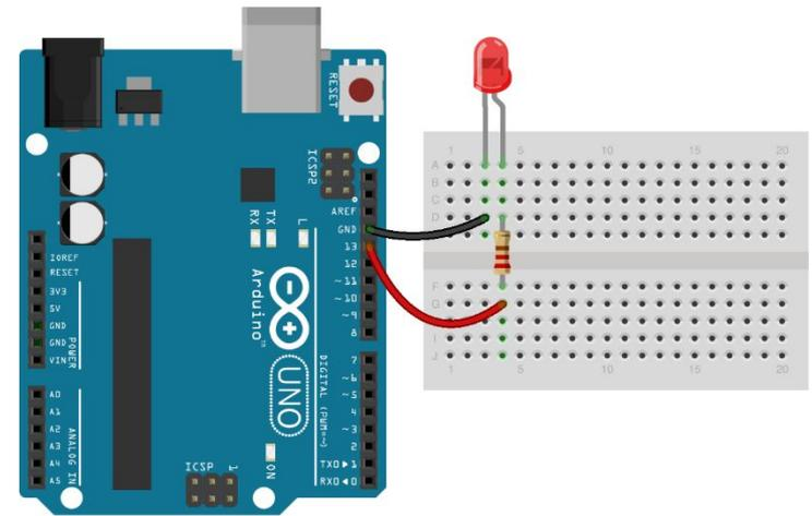
Выходы платформы Arduino могут работать как входы или как выходы.
