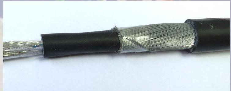
**Ленточная броня** поверх разделительного слоя должна быть наложена броня из двух стальных оцинкованных лент номинальной толщиной не менее 0,20 мм. Ленты должны быть наложены по спирали с зазором таким образом, чтобы верхняя лента перекрывала зазор между кромками нижней ленты
