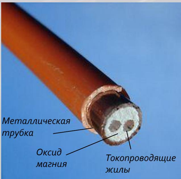
В металлической трубке расположены одна или несколько токопроводящих жил. Пространство внутри оболочки заполнено оксидом магния.
