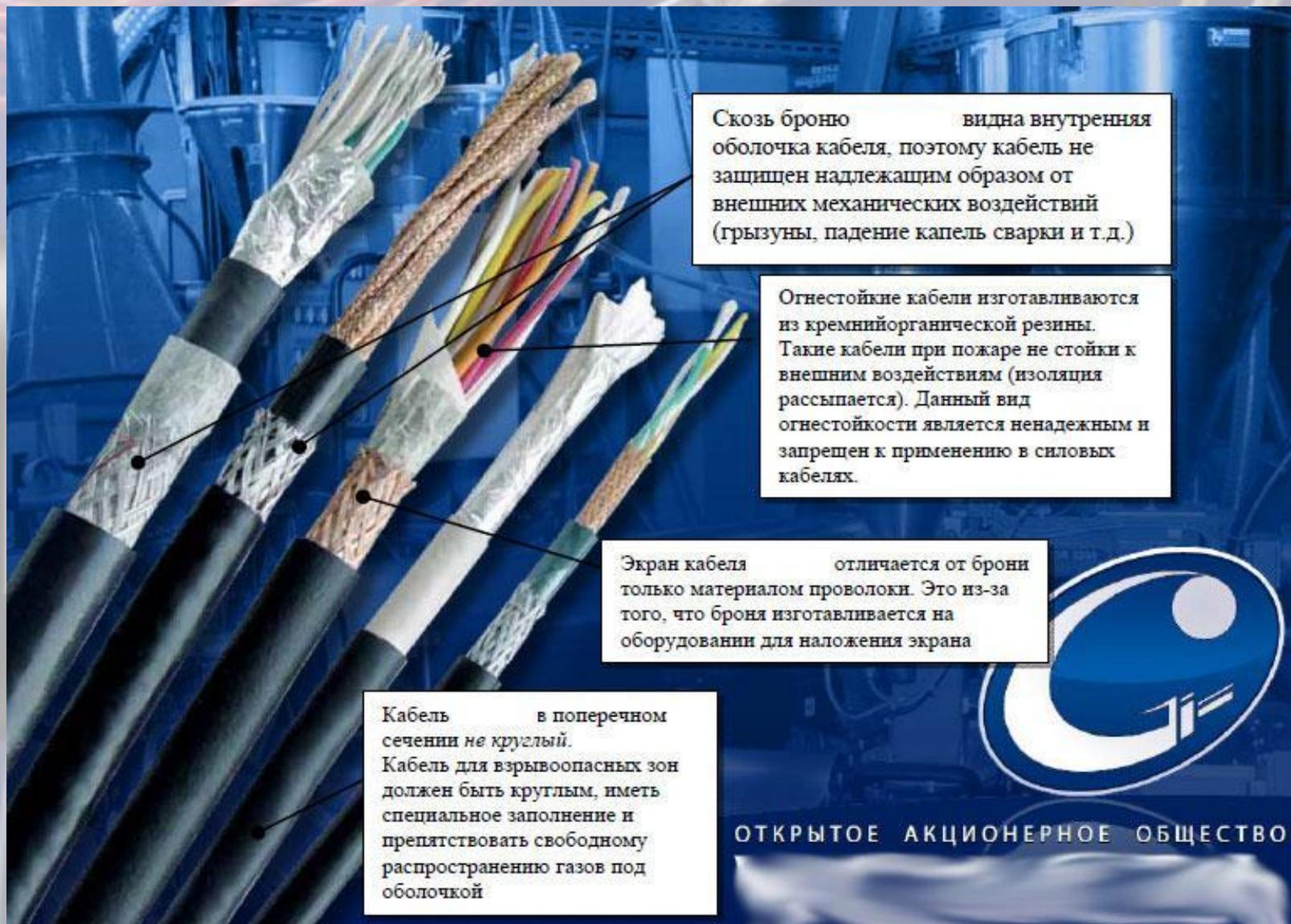
Сквозь броню видна внутренняя оболочка кабеля, поэтому кабель не защищен надлежащим образом от внешних механических воздействий (грызуны, падение капель сварки и т.д.)
