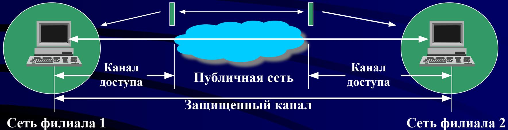
Схемы образования защищенного канала: 1. Программными средствами, установленными на удаленных компьютерах ЛВС предприятия.
