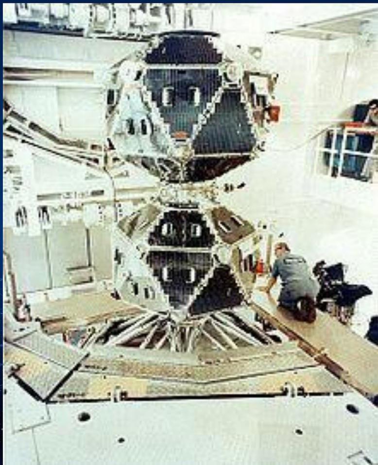
**Спутники Vela-5A/B в комнате сборки. Спутники А и В разделяются после выхода на орбиту.**
