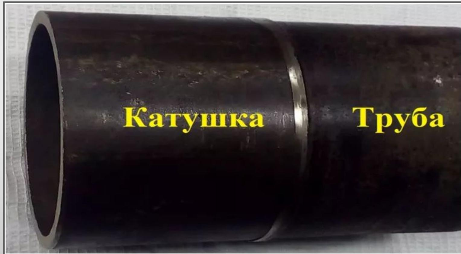
3) При повреждении, нанесенном врезкой запорному устройству или соединительному элементу трубопровода (тройнику, переходнику и т.п.), восстановление производится путем замены дефектной детали на новую.
