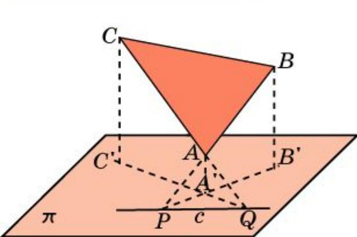
Если даны три точки  $A$ ,  $B$ ,  $C$  плоскости и известны их проекции  $A'$ ,  $B'$ ,  $C'$  на другую плоскость, то для нахождения линии пересечения этих плоскостей находят точки  $P$  и  $Q$  пересечения прямых  $AB$  и  $AC$  со второй плоскостью. Прямая  $PQ$  будет искомой линией пересечения плоскостей.
