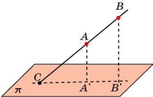
Если даны две точки  $A$  и  $B$  прямой и известны их проекции  $A'$  и  $B'$  на плоскость, то точкой  $C$  пересечения данной прямой и плоскости будет точка пересечения прямых  $AB$  и  $A'B'$
