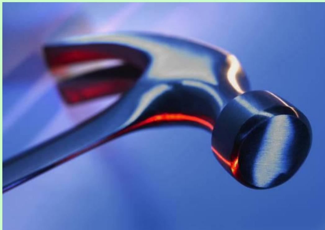
**Качественная – У7, У8 – зубила, молотки, штампы, матрицы, комплекты ключей, плоскогубцы, отвертки и т.д.**
