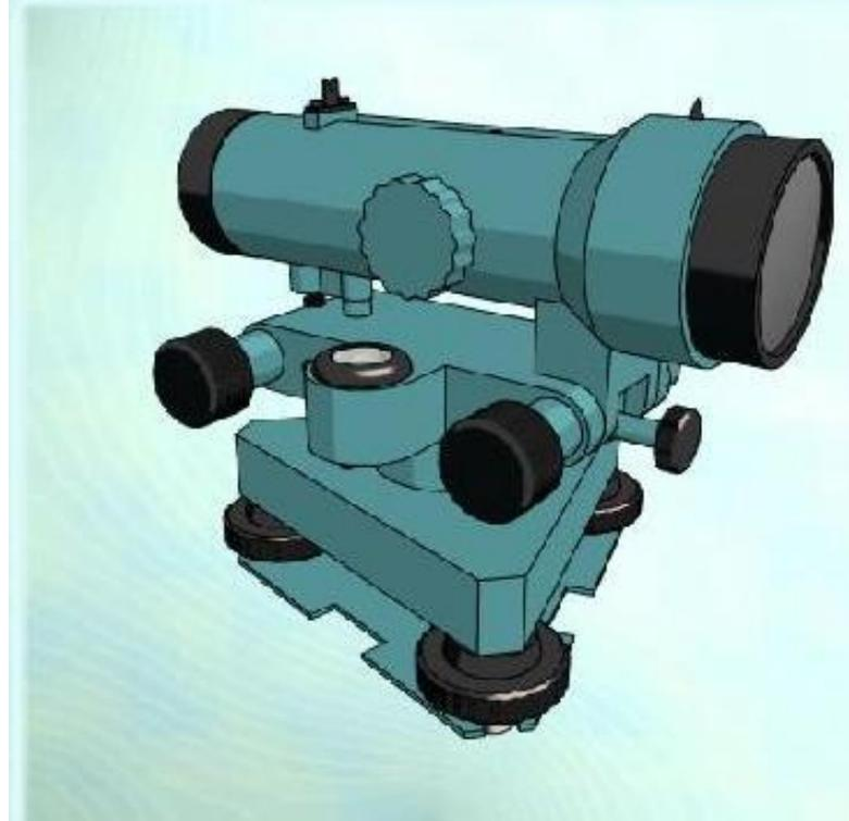
Подставка с тремя подъемными винтами, зрительная труба. Труба имеет закрепительный и наводящий винты.
