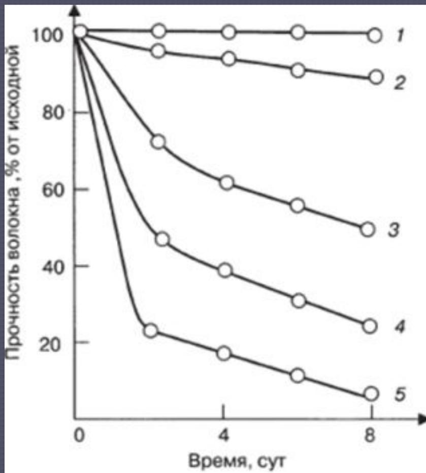
Зависимость разрывной прочности полиамидного волокна (капрон) от продолжительности нагрева на воздухе при различных температурах: 1 — 800 °C; 2 — 1000 °C; 3 — 1200 °C; 4 — 1400 °C; 5 — 1600 °C
