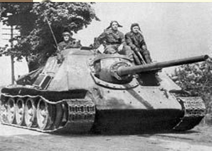
Самоходно-артиллерийская установка была принята на вооружение в 1943 году в следствии необходимости новой установки, так как предназначенные для непосредственной поддержки пехоты и танков СУ-122 обладала слишком малой скорострельностью. Созданная на базе танка Т-34, новая СУ вооружалась 85-мм пушкой Д5-С85.
