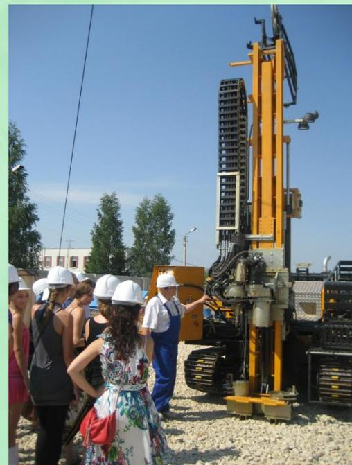
***Установка GM-200 для гидроударного и алмазного бурения***
