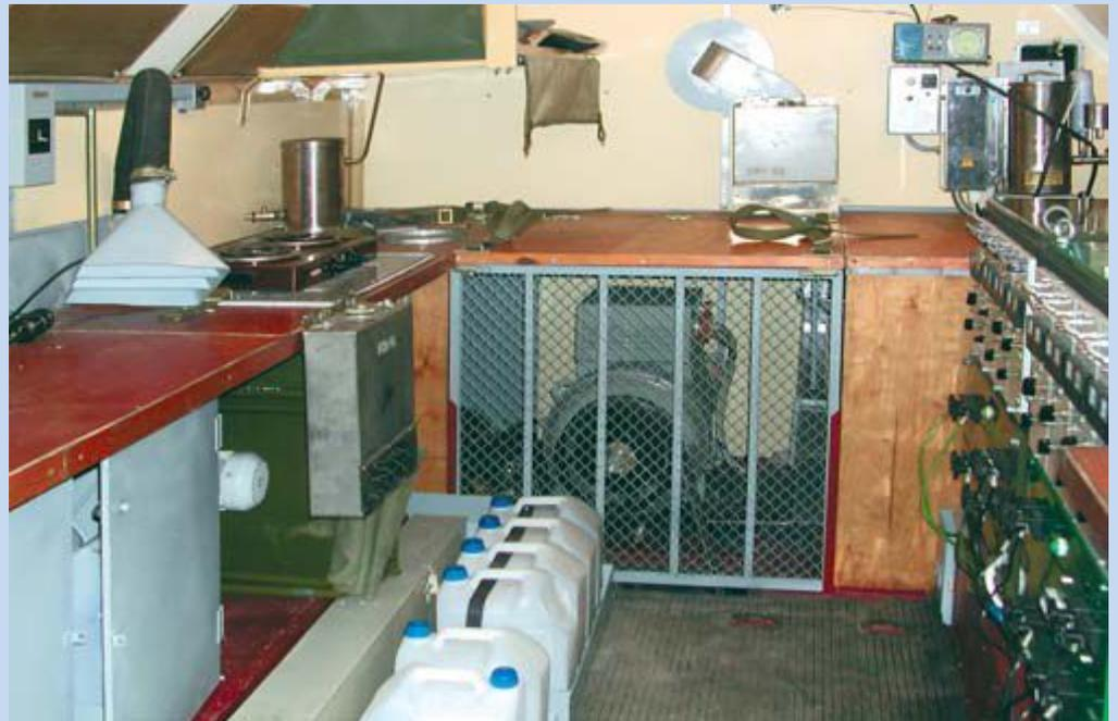
Ремонтно-зарядная аккумуляторная станция СРЗ-А предназначена для ремонта, зарядки и разрядки кислотных аккумуляторных батарей в полевых условиях.
