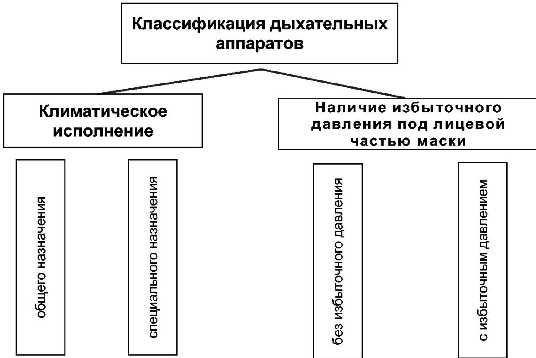
Рис. 3. Классификация дыхательных аппаратов со сжатым воздухом
