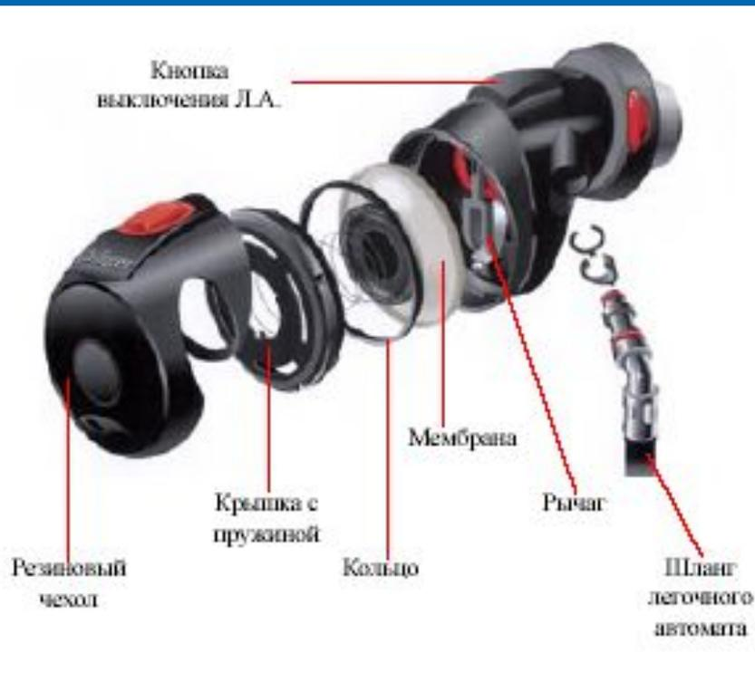
Легочный автомат предназначен для непрерывной подачи воздуха во внутреннюю полость маски для создания избыточного давления (200 – 400 Па), автоматической подачи на вдох, а также включения дополнительной (аварийной) подачи воздуха при отказе легочного автомата или нехватке воздуха пользователю путем нажатия на кнопку аварийной подачи.
