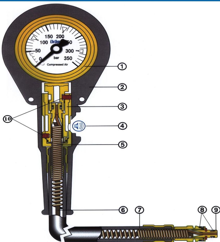
**Манометр:** 1.Индикатор; 2.Защитный кожух; 3.Втулка;
