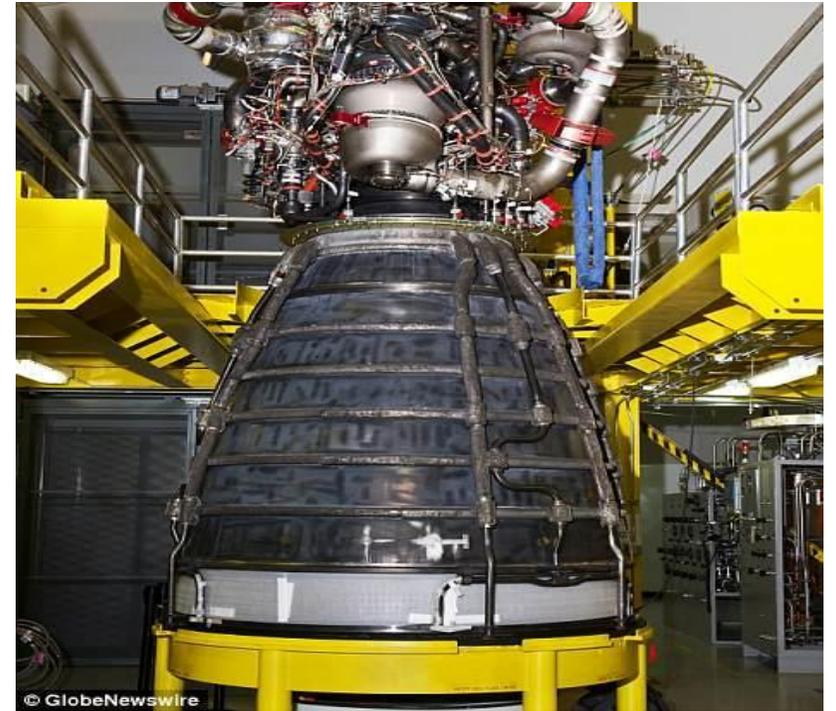
Кислородно-водородный ЖРД Aerojet Rocketdyne AR-22, созданный на базе двигателей RS-25 МТКК Space Shuttle
