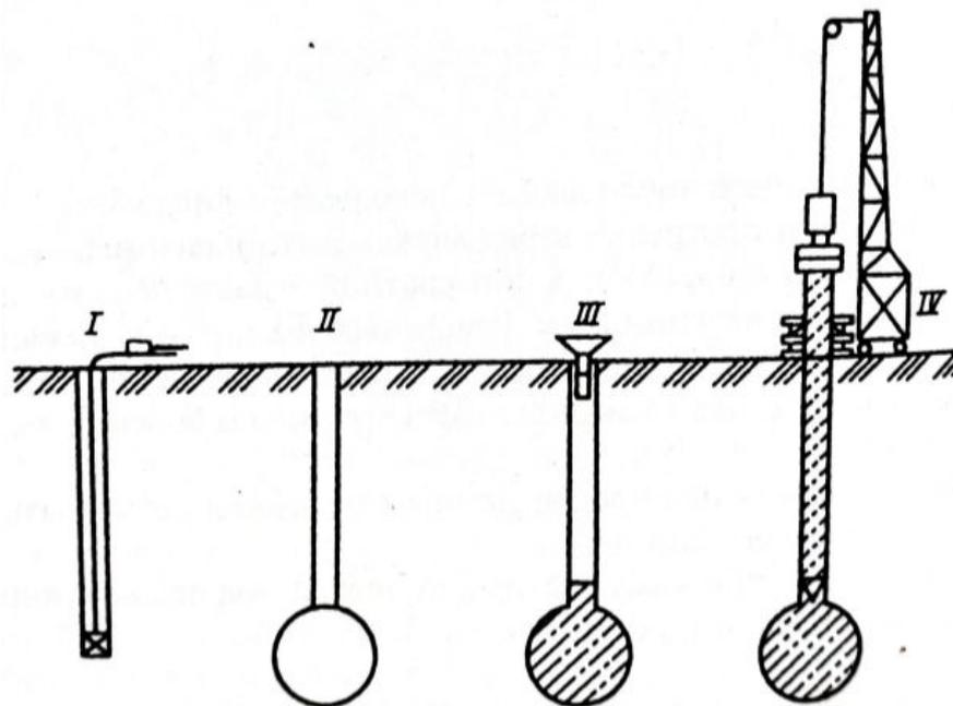
Рисунок 3. Технологии взрывного образования полостей:
