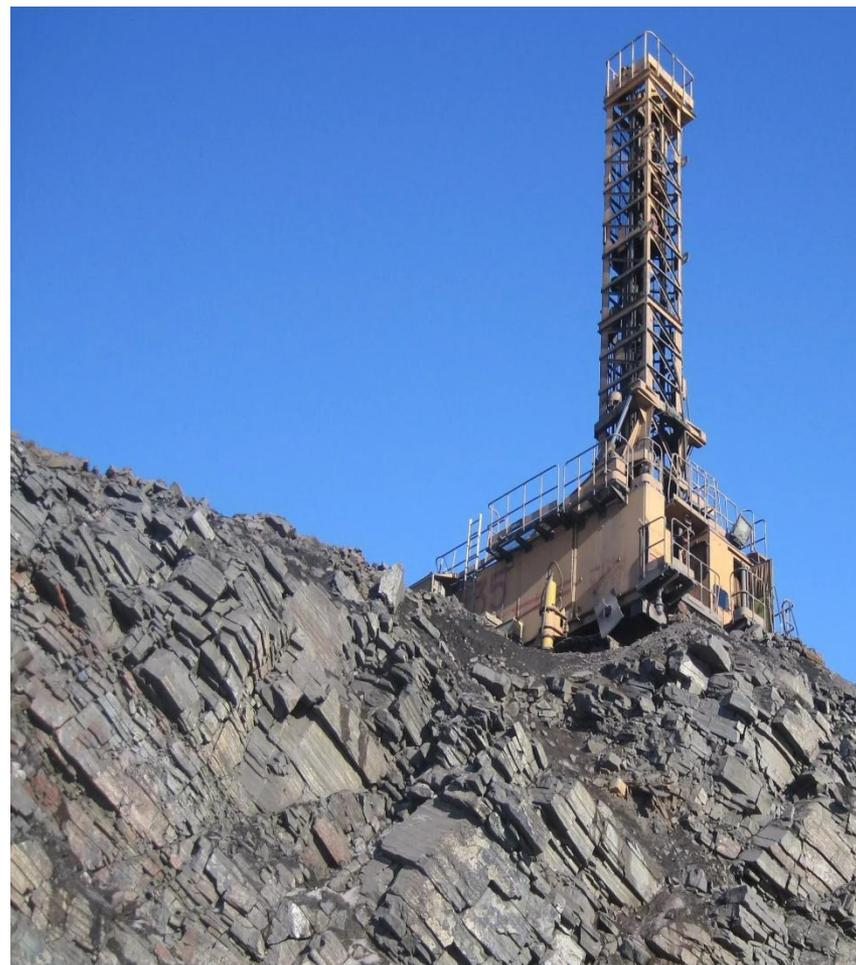
Рисунок 2. Разрушение скальных пород с помощью СБШ 250
