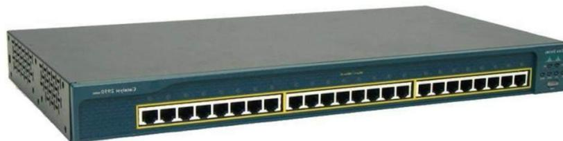
Коммутатор хранит в памяти таблицу коммутации, в которой указывается соответствие MAC-адреса узла сети порту коммутатора.
