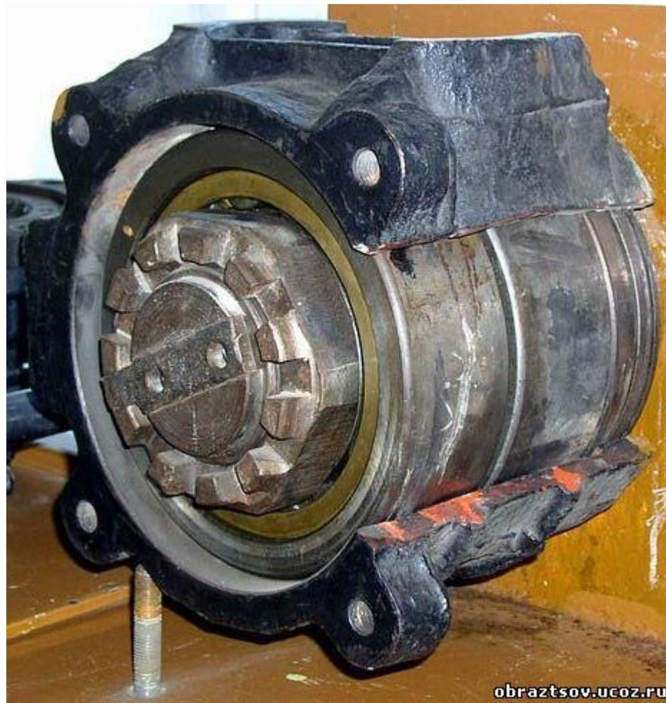
Буксовый узел предназначен для передачи нагрузки от вагона на шейку оси, ограничения перемещений колёсной пары вдоль и поперёк относительно рамы тележки. Внутри корпуса буксы обычно размещаются два роликовых подшипника.
