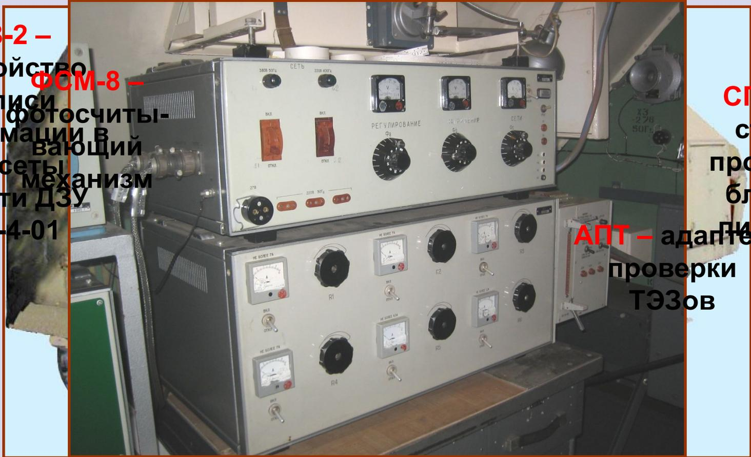
**СПБП** – стенд проверки блоков питания
