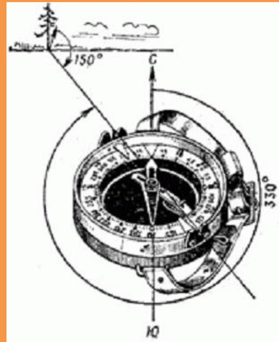
Направления движения выдерживают с помощью магнитного компаса, а расстояния измеряют шагами (парами шагов).
