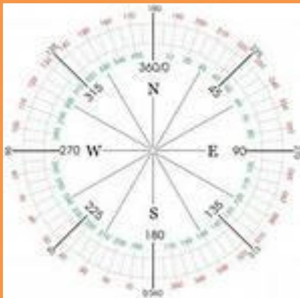
Азимут - это угол между направлением на север и направлением на ориентир (объект). Азимут измеряется в градусах и отсчитывается от направления на север по часовой стрелке. Таким образом, азимут объекта, находящегося строго на восток от наблюдателя, равен 90, на юг соответственно 180, на запад уже 270, а, к примеру, на юго-восток - 135.
