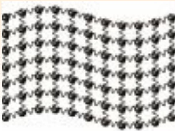
**Поперечная волна в сетке, состоящей из шариков, скреплённых пружинками. Колебания масс происходят перпендикулярно направлению распространения волны.**
