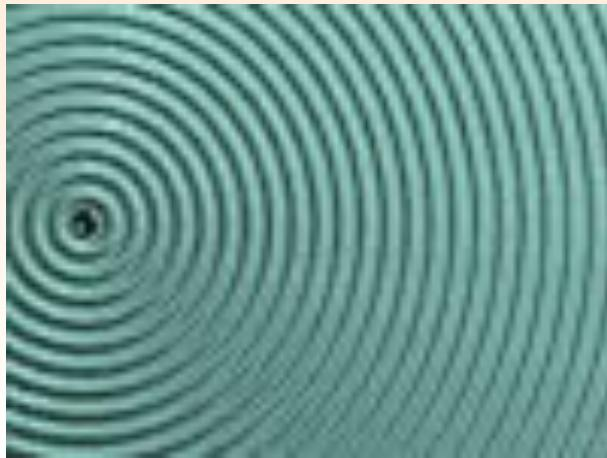
**Круговая волна на поверхности жидкости, возбуждаемая точечным источником (гармонически колеблющимся шариком).**
