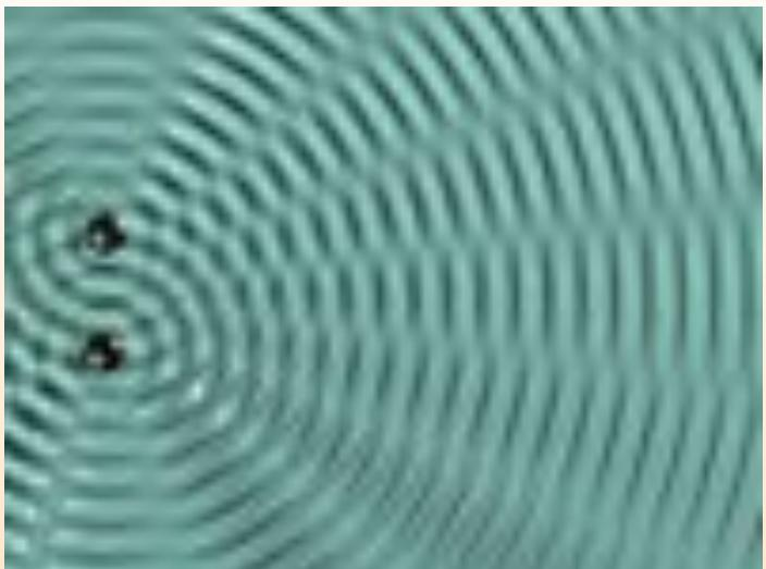
Интерференция между двумя круговыми волнами от точечных источников, колеблющихся в фазе друг с другом. На поверхности жидкости образуются узловые линии, в которых колебание максимально или отсутствует.
