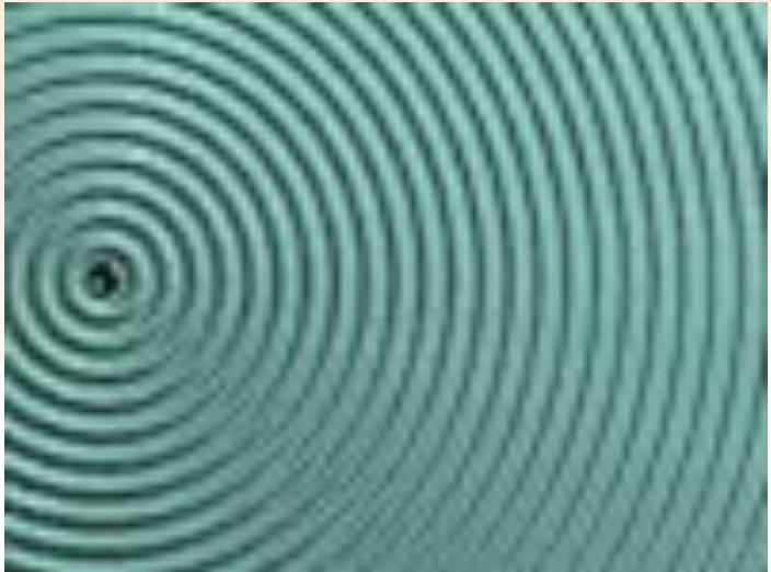
Круговая волна на поверхности жидкости, возбуждаемая гармонически колеблющимся шариком.
