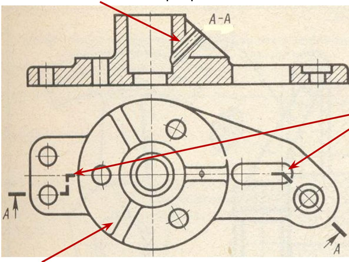
**Допускается применение сложных разрезов, представляющих собой сочетание ступенчатых и ломаных разрезов\*.**
