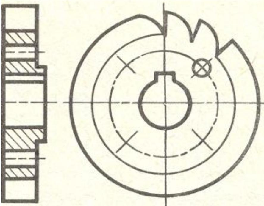
При наличии нескольких равномерно расположенных элементов (зубьев, отверстий) показывают один - два таких элемента, а остальные изображают *упрощенно или условно, но так, чтобы была сохранена ясность расположения всех элементов*
