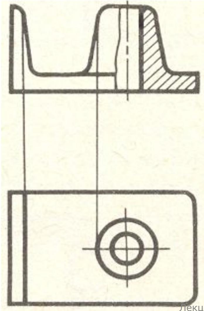
На тех изображениях, где уклон и конусность отчетливо не выявляются, проводят только одну линию, соответствующую меньшему размеру элемента с уклоном или меньшему основанию конуса
