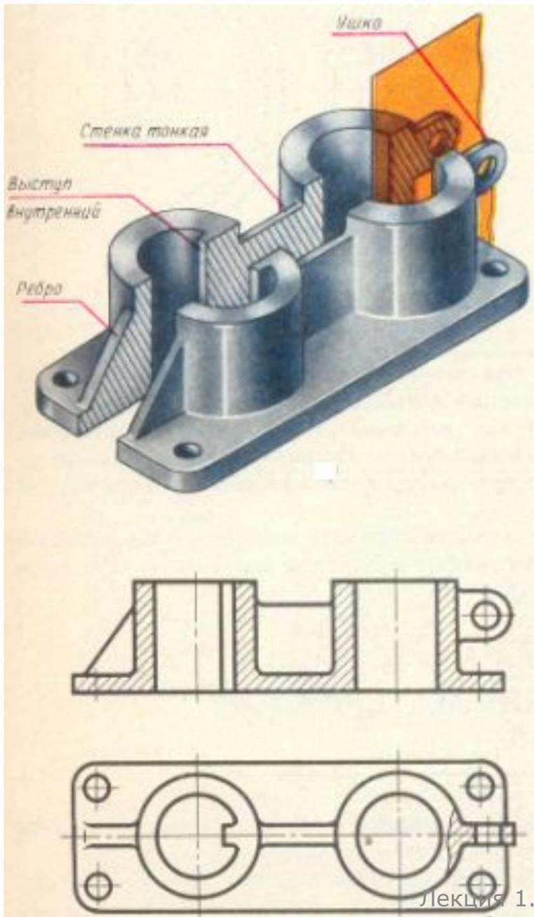
Если секущая плоскость проходит вдоль относительно тонкого элемента детали (стенки, ребра меньше 16 мм и др.), то этот элемент на разрезе рассекается, но **не штрихуется**
