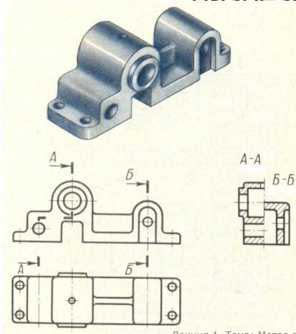
Допускается совмещать два разреза, если каждый из них представляет собой симметричную фигуру
