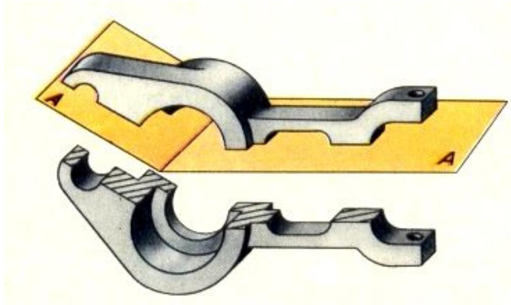
Сложный разрез, полученный при мысленном рассечении предмета двумя или более **пересекающимися** плоскостями, называется **ломаным**
