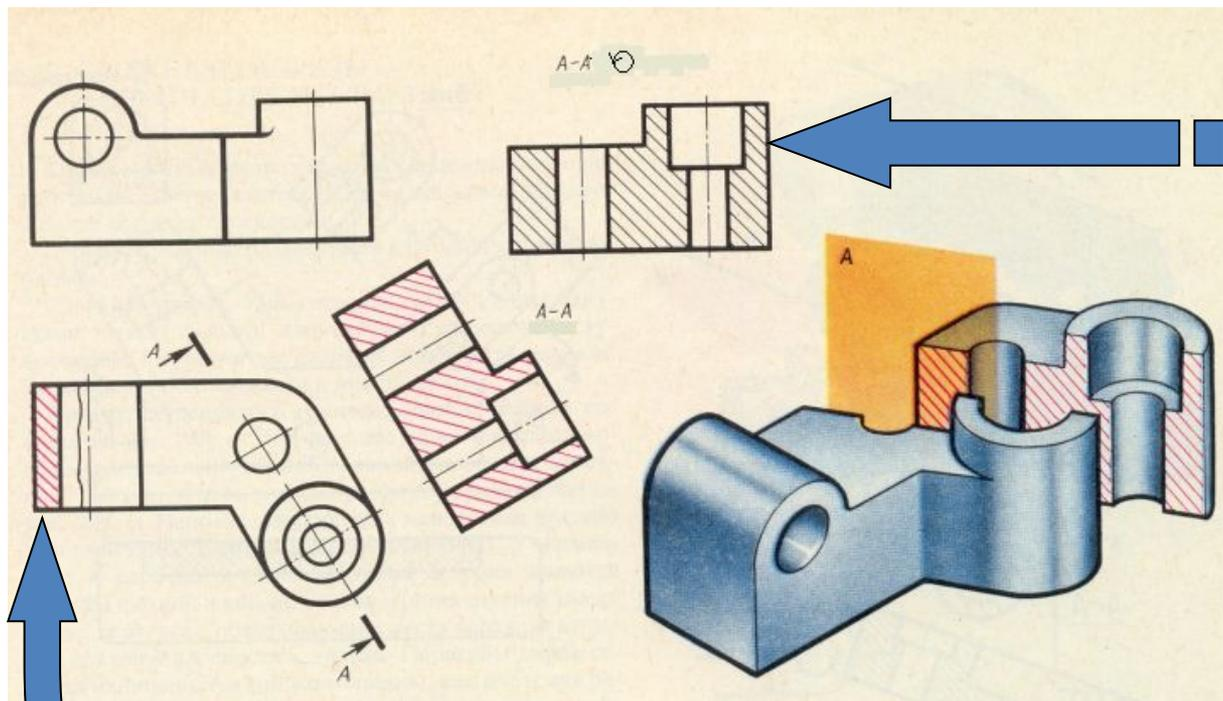
Допускается поворот разреза до положения, соответствующего положению, принятому для предмета на главном изображении
