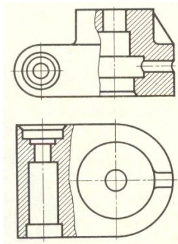
Лежащие в разных плоскостях штриховые линии, проецируясь на плоскость чертежа, затрудняют его прочтение
