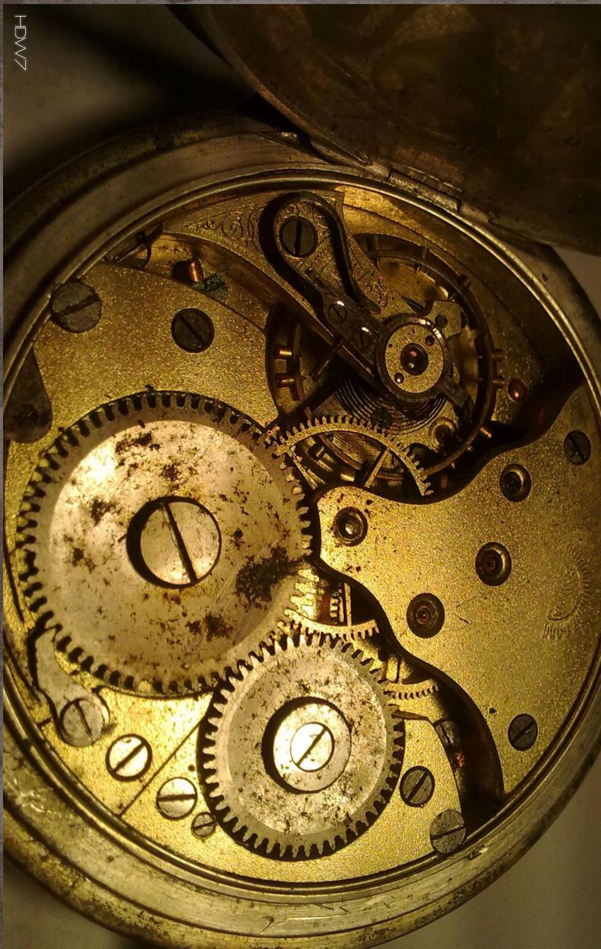
При оценке часов используют показатели среднего суточного хода за определенный период (для наручных часов за 4 суток) и максимального его значения за этот период. На точность механических часов влияют качество регулировки, калибр, продолжительность хода, количество камней (применяются в узлах трение механизма, они снижают потери энергии на трение, что равноценно увеличению продолжительности хода), позиционная и температурная погрешности.
