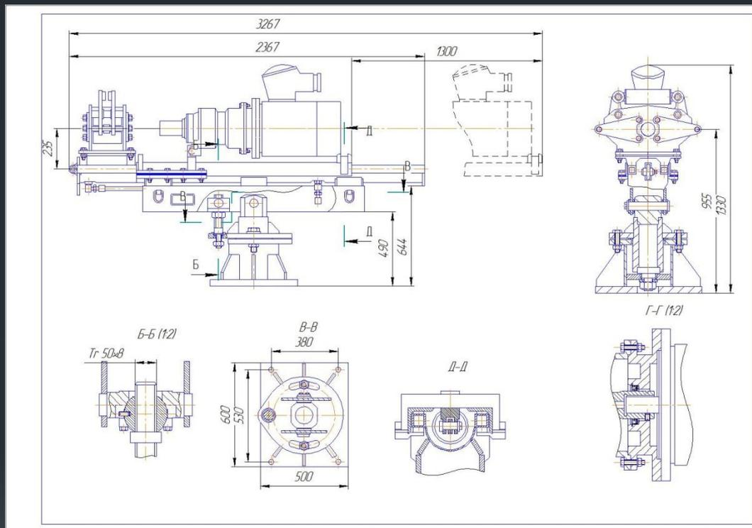
Станок предназначен для бурения опережающих скважин, которые проводят впереди забоя горной выработки в угольном пласте или горной породе для частичной разгрузки их от давления и дегазации, благодаря чему устраняется или снижается опасность возникновения внезапного выброса угля и газа.
