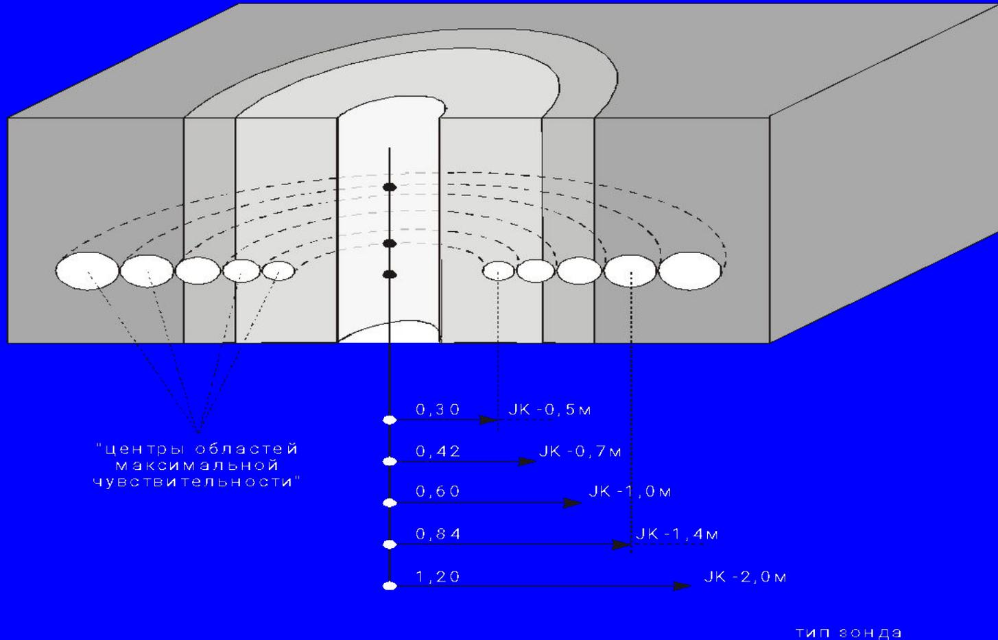
Рис.1 Схема концентрации электромагнитных откликов изопараметрических зондов ВИКИЗ.
