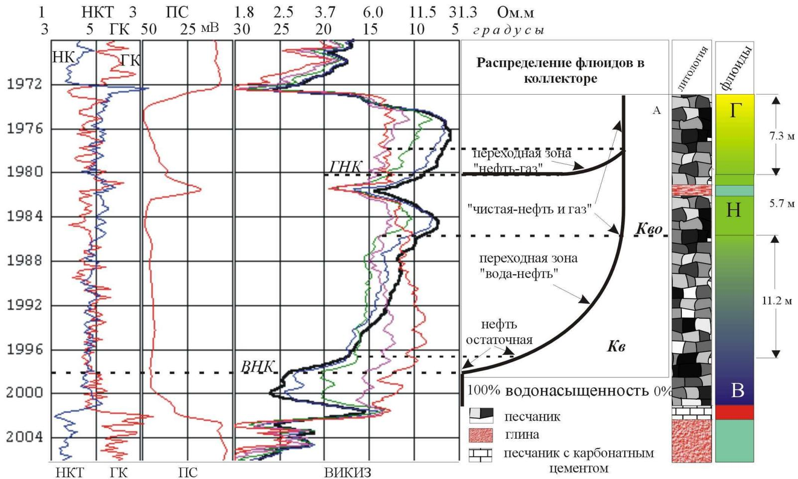
Рис.3. Разрез залежи пластов АС\_7-8. Федоровское месторождение.
