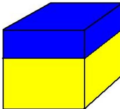
Единичный куб породы с пористостью 40%, насыщенный водой сопротивлением  $R_w$  -  $S_w=100\%$ ,  $BVW=40\%$
