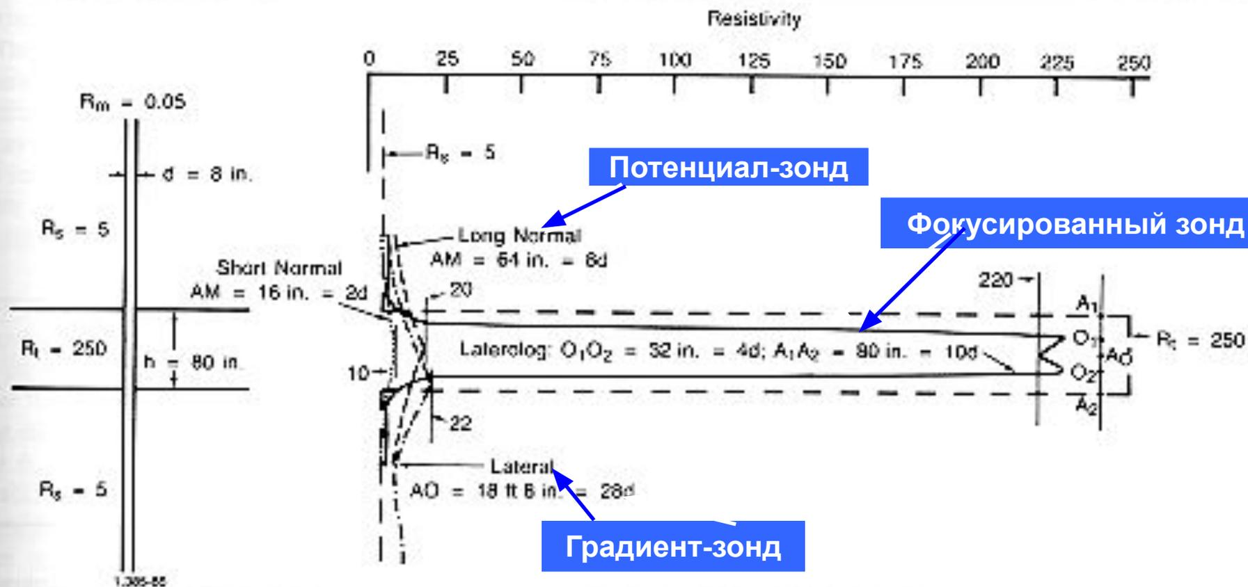
Отклики фокусированного и обычных зондов от тонкого слоя высокого сопротивления, без зоны проникновения при очень соленом буровом растворе (лабораторные исследования)
