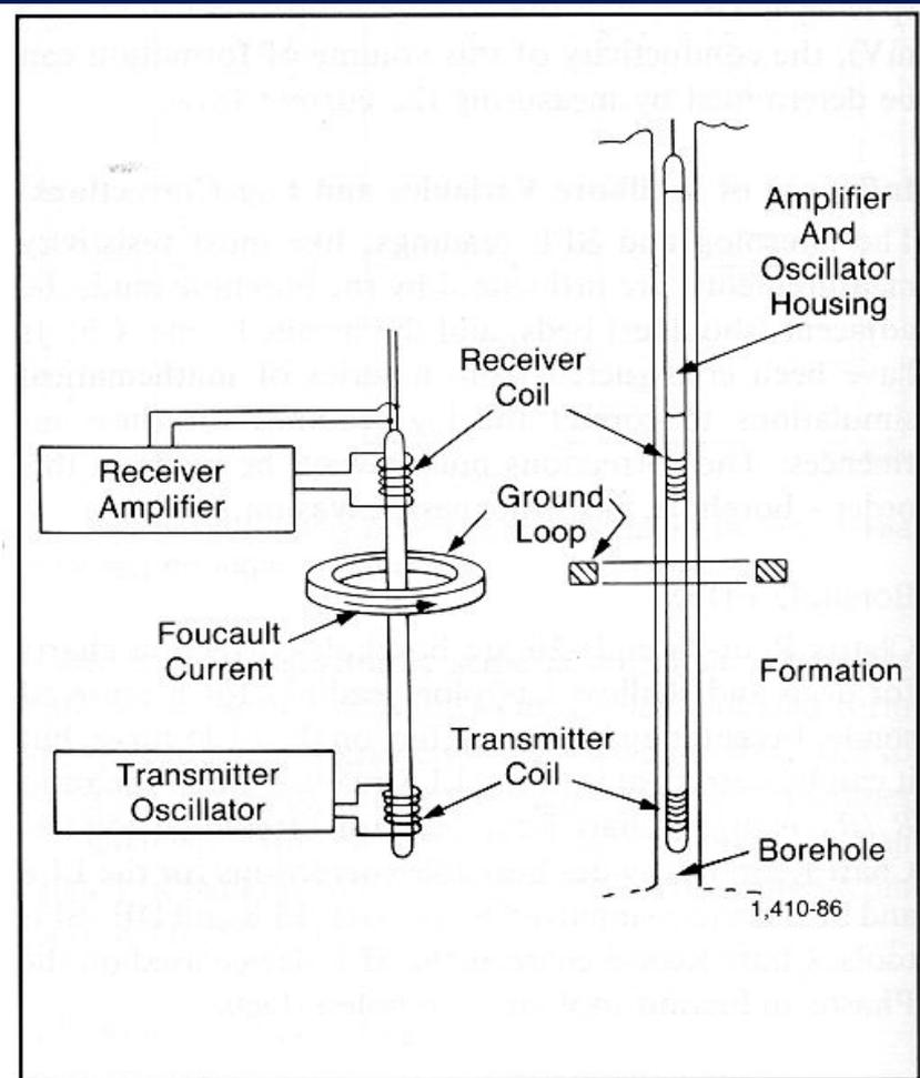
Большинство индукционных приборов состоит из совокупности излучателей и приемников, которые производят измерение на определенном расстоянии в пласте, обычно 40 дюймов (1 м) для ILD (глубинный) и 28 дюймов (0,7 м) для ILM (средний).
