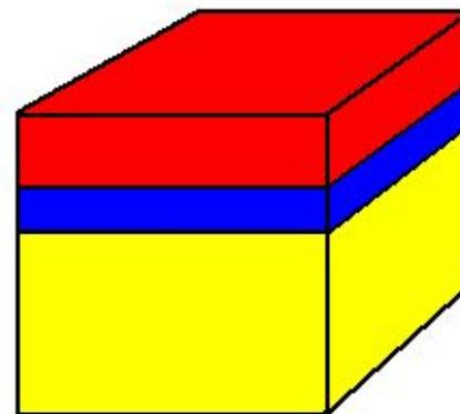
Единичный куб породы с пористостью 40%, насыщенный водой сопротивлением  $R_w$  - ( $S_w=40\%$ ) и углеводородами.  $S_{hy}=60\%$ ,  $BVW=16\%$ ,  $BV_{hy}=24\%$
