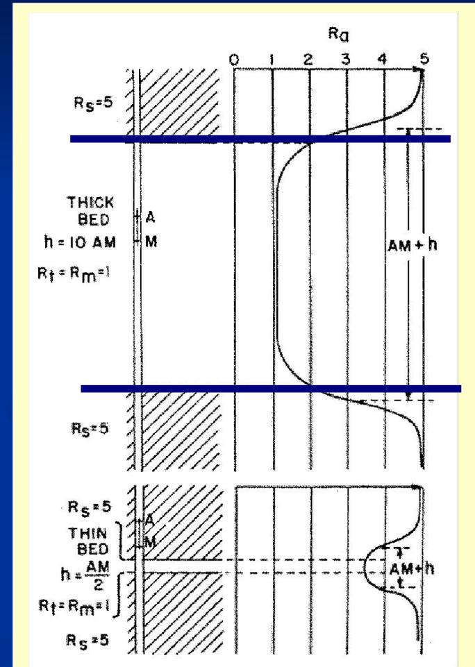
43 Кривые КС потенциал-зонда в случае непроводящих и проводящих слоев и положение границ пластов
