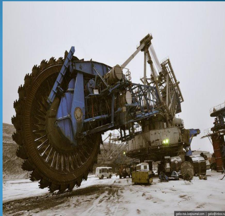
Ковши закреплены на жестком роторе.
