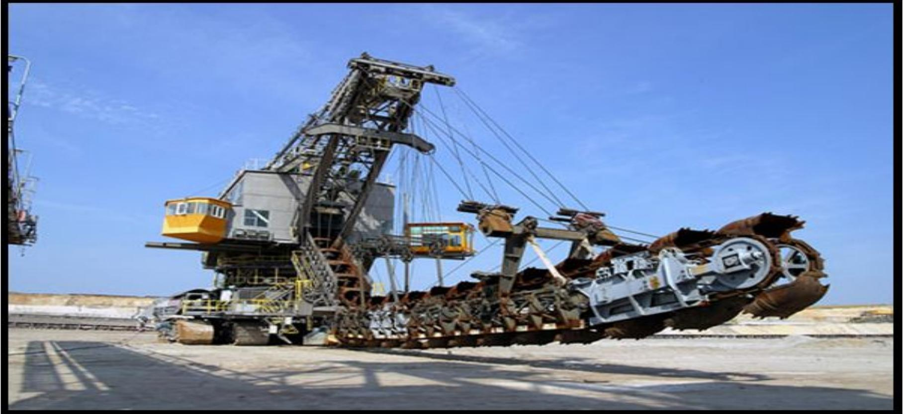
**Экскаваторы непрерывного действия** - машина, непрерывно разрабатывающая грунт с одновременной погрузкой его в транспортное средство или укладкой в отвал
