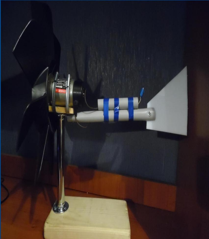
Опытным путём я решил доказать, что возможно создание и применение ветрового генератора. Для создания модели ветрового генератора мне понадобился двигатель, несколько лопастей и лампочка 1,5 ватт.
