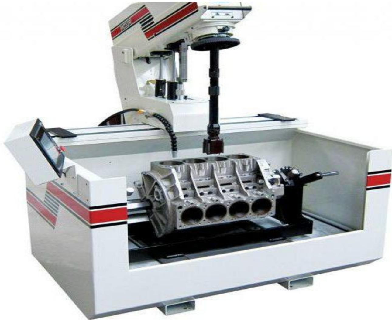
В процессе хонингования происходит абразивное воздействие на поверхность обрабатываемой детали. Целью является получение нужной шероховатости поверхности и достижение необходимой точности размеров с помощью хонинговального инструмента
