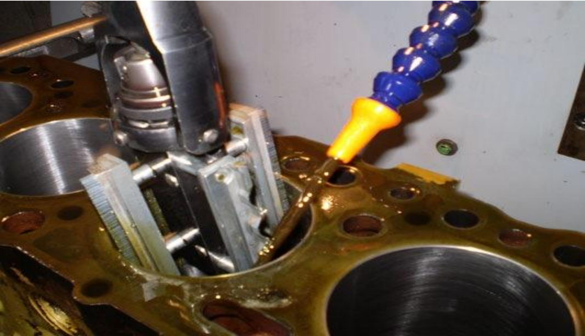
В случаях, когда блок двигателя изношен незначительно, возможно применение специальных хонинговальных щеток, которые используются даже в ручных дрелях для быстрого восстановления хона
