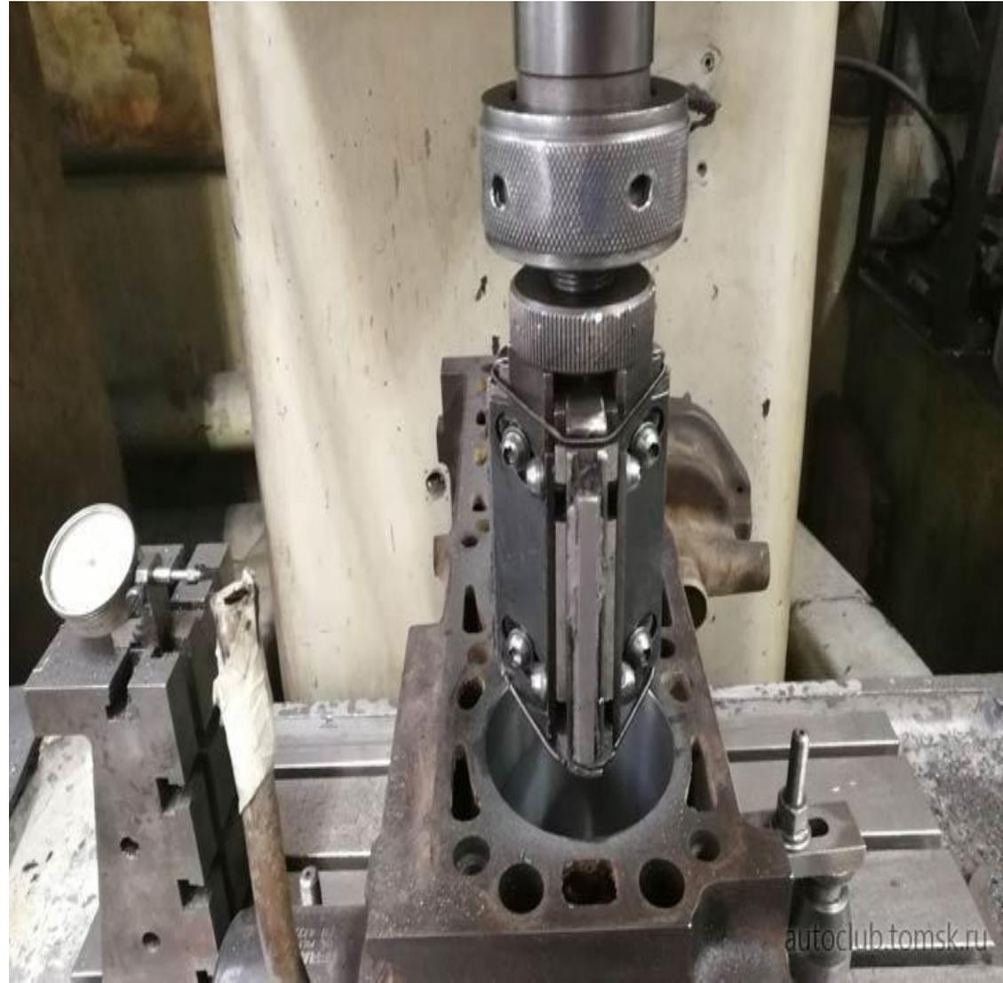
**Платохонингование** по сравнению с обычным имеет свои особенности. Применяется для обработки блока цилиндров. Между цилиндрами и кольцами существует зазор, который заполняется маслом. Формируется он автоматически в первое время работы двигателя. Для этого с помощью платохонингования поверхностный слой сопрягаемых деталей делается рыхлым. В процессе работы он стирается, и детали надежно прилегают друг к другу. Минимальный оставшийся зазор заполняется маслом
