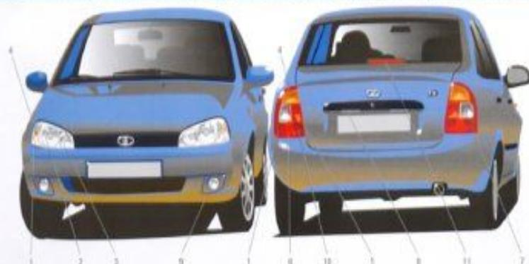
Внешние световые приборы легкового автомобиля: 1 – габаритные огни; 2 – фары ближнего света; 3 – фары дальнего света; 4 – указатели поворота; 5 – фонари сигнала торможения; 6 – заднее световозражающее устройство; 7 – фары заднего хода; 8 – фонари освещения заднего государственного регистрационного знака; 9 – противотуманные фары; 10 – задние противотуманные фонари; 11 – дополнительный сигнал торможения.
