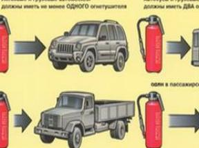
Легковые и грузовые автомобили, предназначенные для перевозки людей, должны иметь не менее ОДНОГО огнетушителя.
