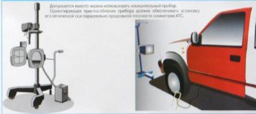
Допускается вместо экрана использовать измерительный прибор. Ориентировочное приспособление прибора должно обеспечивать установку его оптической оси параллельно продольной плоскости симметрии АТС.
