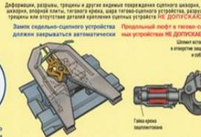
Дефектные шарниры, тросы и другие элементы тягово-сцепного устройства, тягово-сцепного звена, тягово-сцепного устройства, шарниры, тросы или другие детали крепления должны быть ДОПУСКАЮТСЯ.
