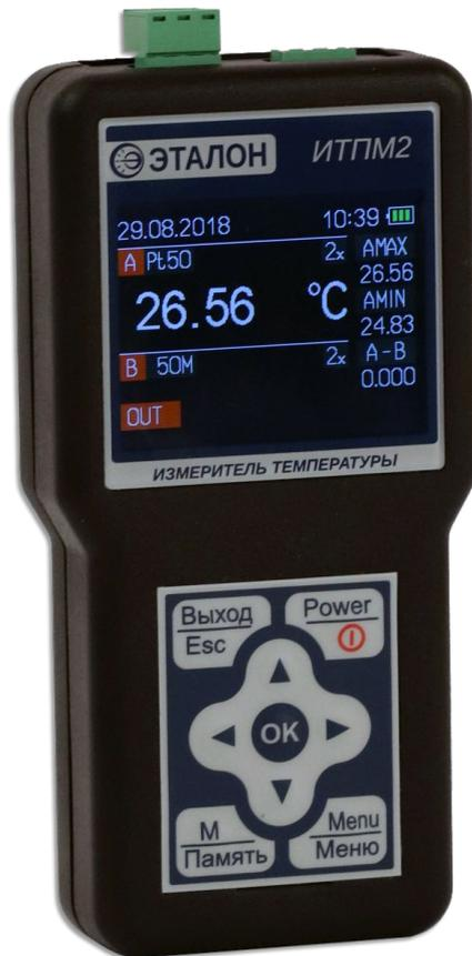
ИТПМ2 предназначен для измерения температуры при помощи преобразователей термоэлектрических (ТП) и термопреобразователей сопротивления (ТС) по одному или двум независимым каналам.
