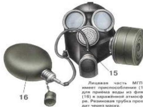
Лицевая часть МП-В имеет приспособление (15) для приёма воды из фляги (16) в заражённой атмосфере. Резиновая трубка проходит через маску.
