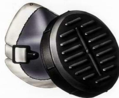
Респиратор многоразового использования со сменным фильтром. Защищает от силикатной, металлургической, горнорудной, угольной, табачной пыли, пыли порошкообразных удобрений и интоксидов, не выделяющих токсических газов. Широко применяется шахтёрами при высокой запылённости (500 мг/м<sup>3</sup> и более). Масса — 250 г.
