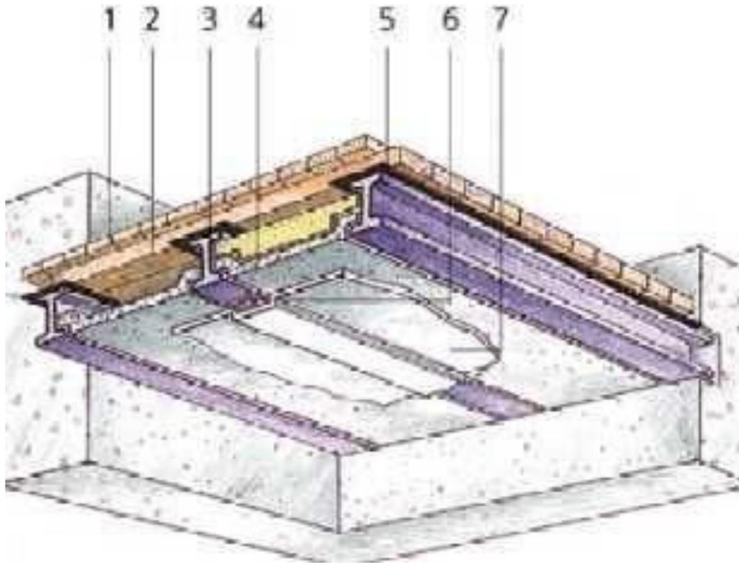
1 - " чистый " пол ; 2 - дощатый настил ; 3 - балка ; 4 - сборная ж/б плита ; 5 - гидроизоляция ; 6 - штукатурная сетка
