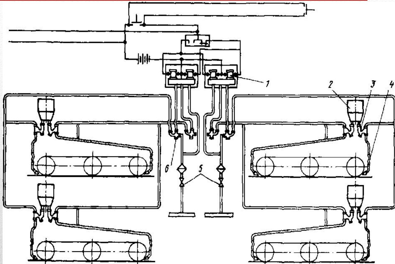
1- электропневматический клапан; 2 - песочный бункер; 3 - форсунка; 4 - гибкий шланг; 5 - разобшительный кран; 6 - воздухораспределитель.
