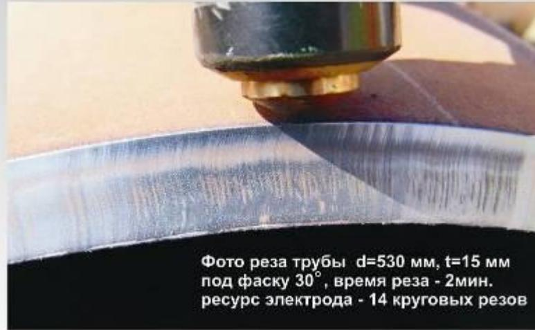
Фото реза трубы  $d=530$  мм,  $t=15$  мм под фаску  $30^\circ$ , время реза - 2 мин. ресурс электрода - 14 круговых резов
