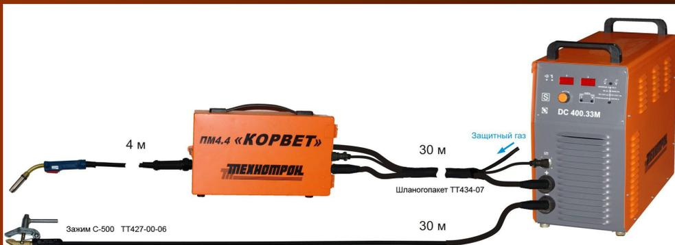
Схема сборки при сварке в режиме
