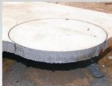
Сталь 12X17H10T  $t=36 \text{ мм}$   $d=340 \text{ мм}$
