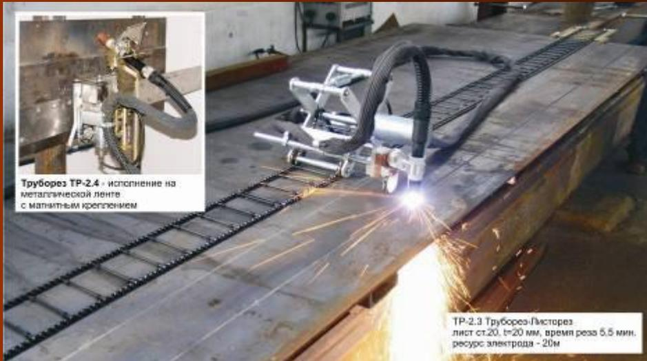
Труборез ТР-2.4 - исполнение на металлической ленте с магнитным креплением
