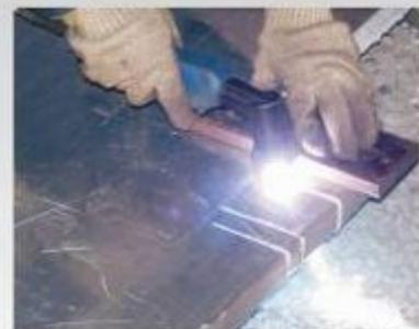
Ручная резка заготовок по линейке
