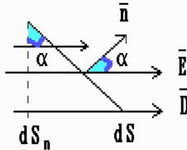
$$d\Phi_E = \vec{E} d\vec{S} = E dS \cos(\vec{E} \wedge \vec{n}) = E dS_n = E_n dS, \text{ В}\cdot\text{м}$$
