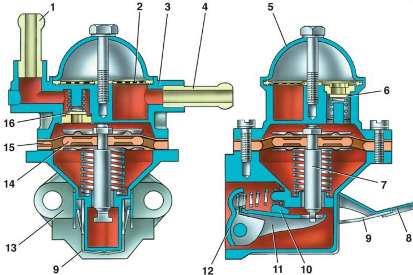
1 – нагнетательный патрубок; 2 – фильтр; 3 – корпус; 4 – всасывающий патрубок; 5 – крышка; 6 – всасывающий клапан; 7 – тяга; 8 – рычаг ручной подкачки топлива; 9 – пружина; 10 – эксцентрик; 11 – балансир; 12 – рычаг механической подкачки топлива; 13 – нижняя крышка; 14 – внутренняя дистанционная прокладка; 15 – наружная дистанционная прокладка; 16 – нагнетательный клапан.
