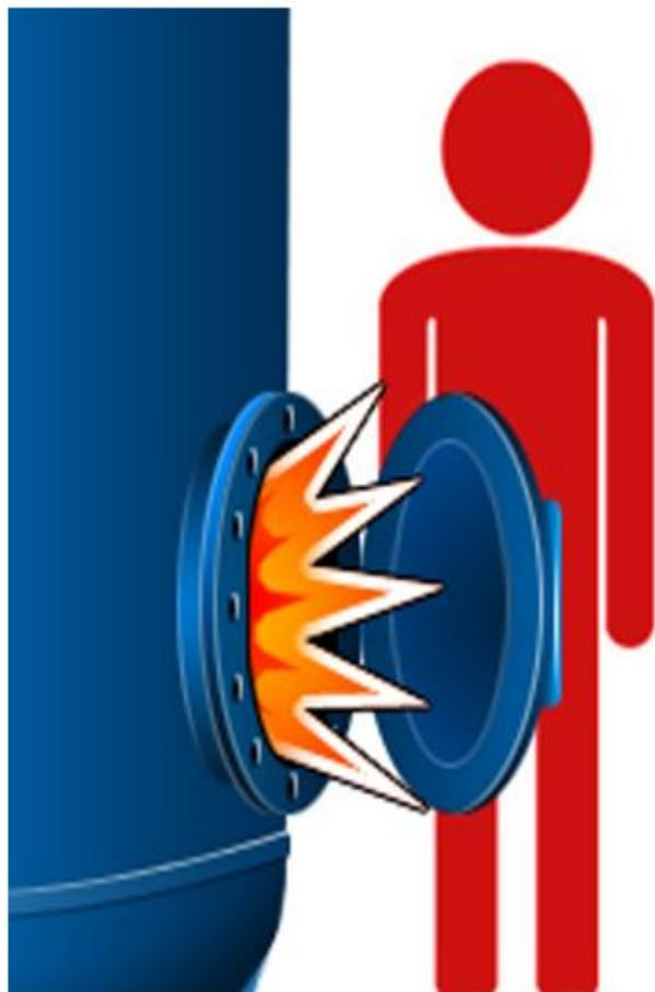
Сосуды, снабженные быстросъемными крышками, должны иметь **предохранительные устройства**, исключающие возможность включения сосуда под давление при неполном закрытии крышки и открывании ее при наличии в сосуде давления. Такие сосуды также должны быть оснащены замками с ключ-маркой.
