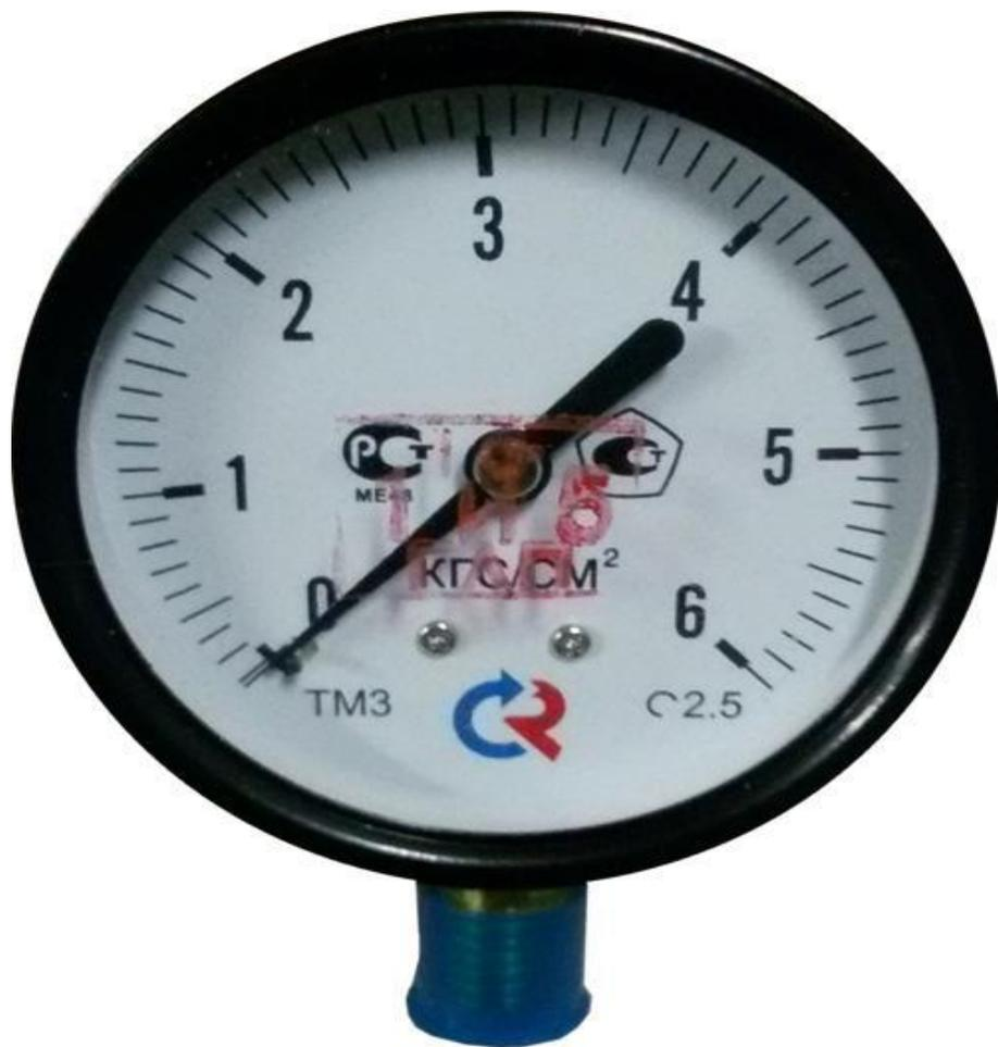
Обозначение 2,5 означает, что максимально допустимая погрешность измерений манометра составляет 2,5% от его диапазона измерений.
