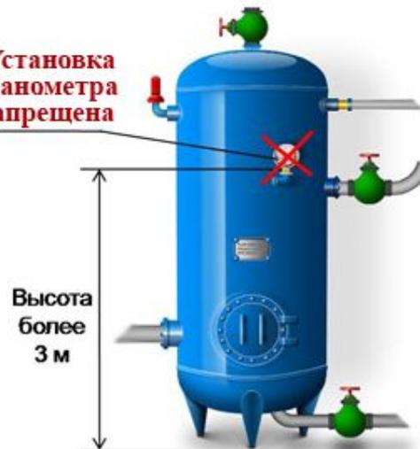
Номинальный диаметр корпуса манометров, устанавливаемых на высоте менее 2 м от уровня площадки наблюдения за ними, должен быть не менее 100 мм, на высоте от 2 до 3 м включительно - не менее 160 мм."
