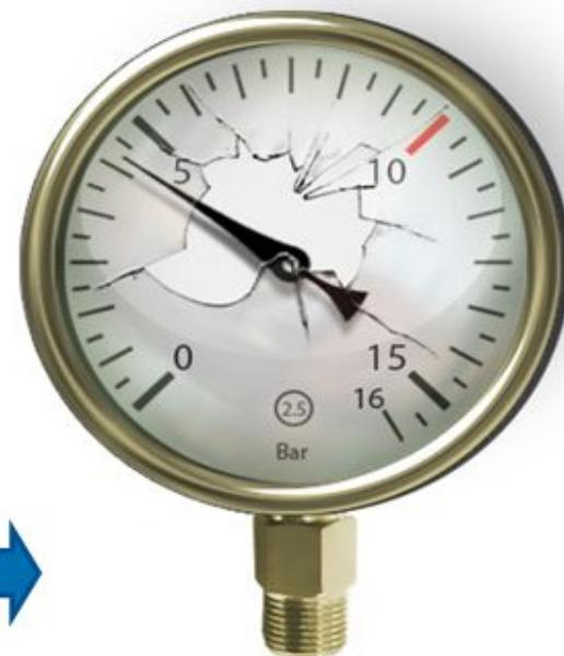
Манометры должны быть с такой шкалой, чтобы при рабочем давлении стрелка их находилась в средней трети шкалы. На циферблате манометра должна быть нанесена красная черта по делению, соответствующему высшему допускаемому рабочему давлению.
