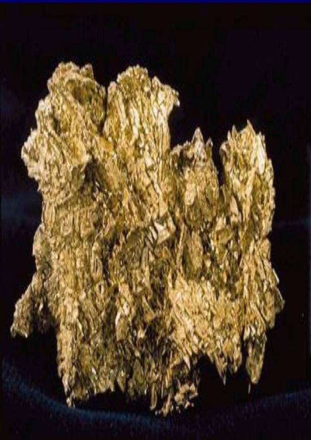
По своей химической стойкости и механической прочности золото уступает большинству платиноидов, но незаменимо, как материал для электрических контактов. Поэтому в микроэлектронике золотые проводники и гальванические покрытия используются очень широко.
