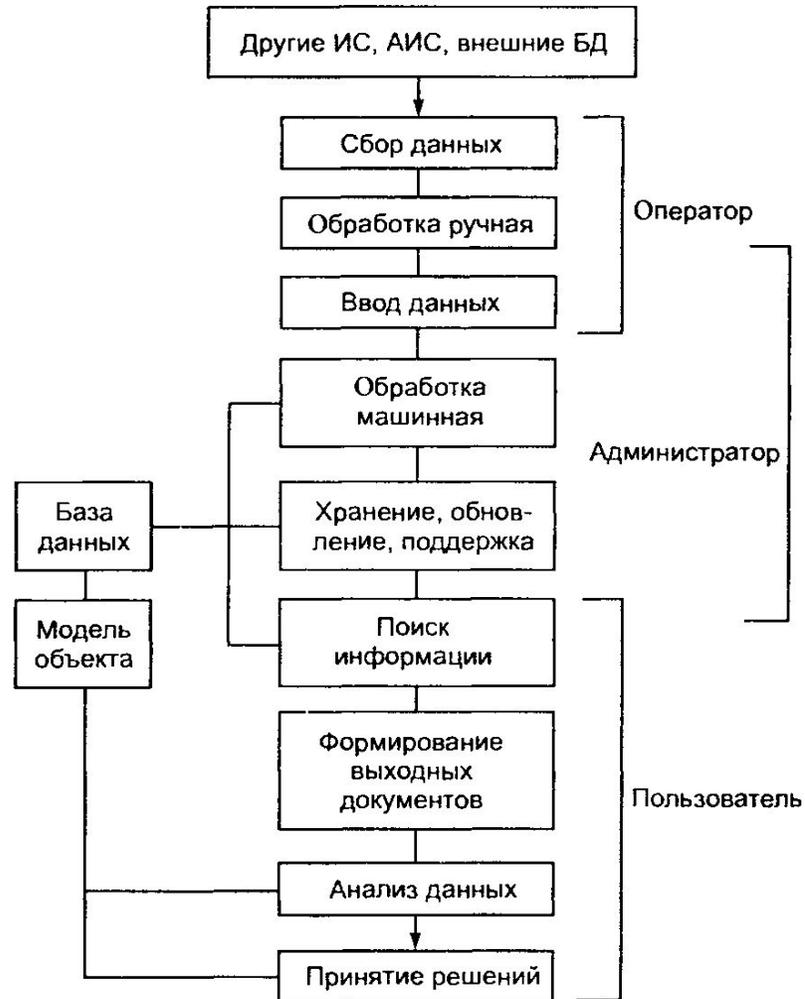
Рис. 5.6. Основные технологические процессы АИС
