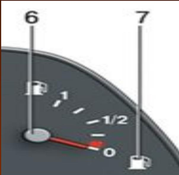
6. Указатель, который показывает количество топлива в баке. Датчик электромагнитный, работает при включенном зажигании. Цена деления: 0 – топливо отсутствует,  $\frac{1}{2}$  – полбака, 1- полный бак.
