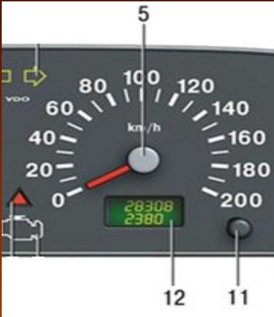
5. Спидометр – прибор, который показывает скорость движения автомобиля.
