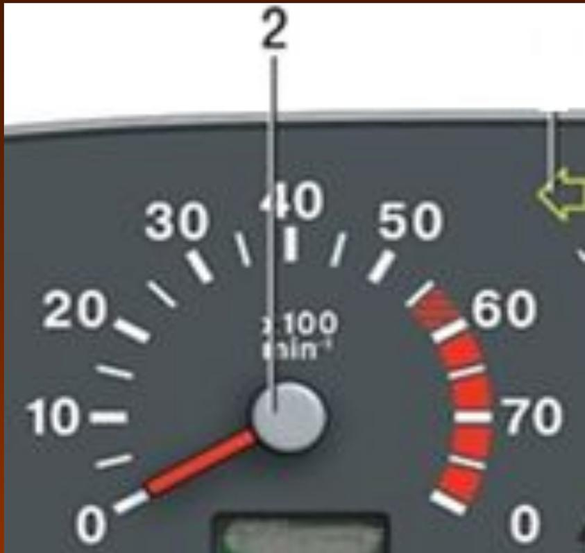
2. Тахометр – прибор, который показывает частоту вращения коленчатого вала двигателя. Цена деления равна 5. Если хотите узнать частоту вращения коленчатого вала, необходимо показание стрелки умножить на 100. Красная зона показывает опасный режим работы двигателя.
