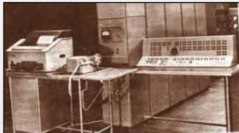
В 1959 г. выпущена отечественная вычислительная машина **Сетуль**, работающая в троичной системе счисления.
