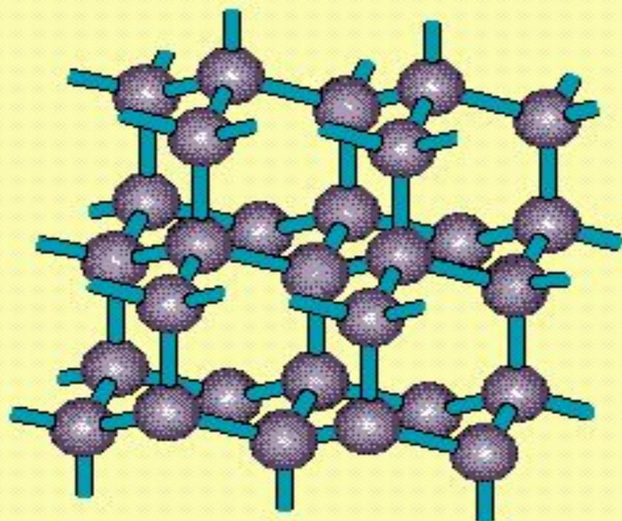
**Пространственная решетка алмаза состоит из атомов углерода в  $sp^3$ -гибридизованном состоянии.**
