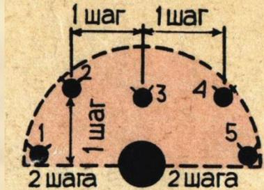
Одна ПТ, пять ПП фугасных мин в точках 1, 2, 3, 4 и 5 и одна ПП осколочная мина действия в точке 6
