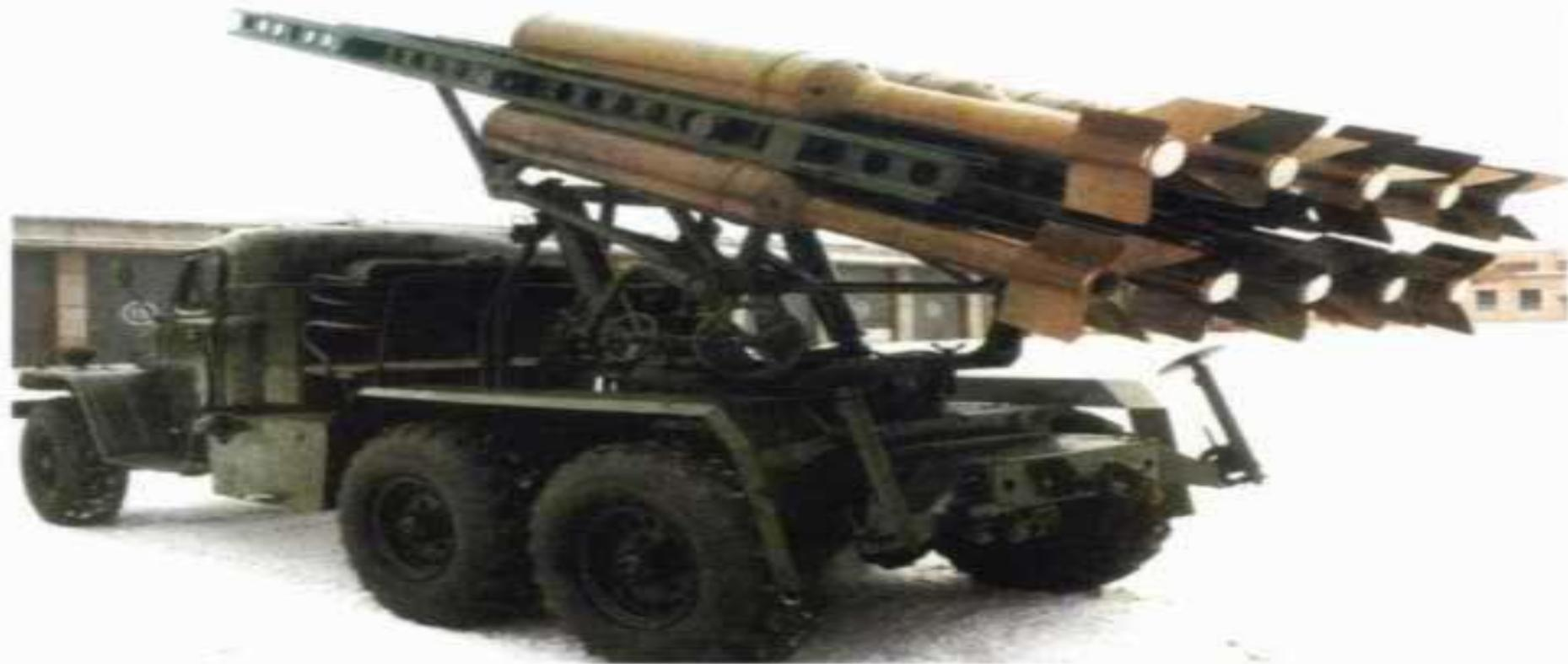
Смонтирована на базе автомобиля высокой проходимости (6 x 6) СА - 30А (аналог советского ЗИЛ-157). Пусковая установка (ПУ) имеет пять парных рельсовых направляющих длиной 4 м. Минирование ведется побатарейно (четыре ПУ). Залп одной ПУ производится за 15с. При стрельбе ракетой типа «74» батарея выставляет заграждение на участке местности площадью 400 x 400 м' на максимальную дальность 1 500 м. а при стрельбе НУР типа «85» - 700 x 500 м: и на 3 000 м.
