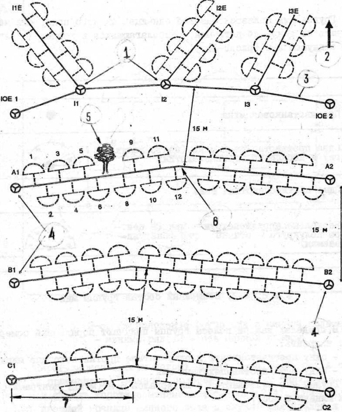
**Размещение мин в заграждении, устанавливаемом по стандартной схеме:**
