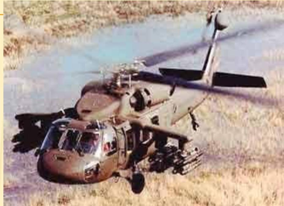
Модульная система минирования состоящая из 4 модулей (контейнеров), в каждом из которых размещается по 40 кассет M87 или M87A1 (в кассете M87 5 противотанковых мин BLU-91/B и 1 противопехотная мина BLU-92/B; а в кассете M87A1 только 6 противотанковых мин BLU-91/B) + транспортное средство. В качестве транспортного средства используется грузовой автомобиль, (грузоподъемность 5 тонн), гусеничный транспортер M548 или вертолет UH-60 "Black Hawk".
