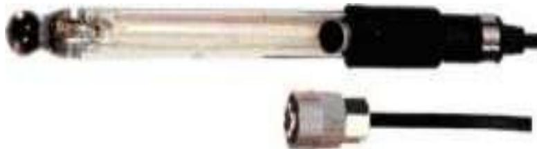
**Потенциометрические измерения проводят, опуская в раствор два электрода – *индикаторный*, реагирующий на концентрацию определяемых ионов, и стандартный электрод или *электрод сравнения*, относительно которого измеряется потенциал индикаторного. Применяют несколько видов индикаторных и стандартных электродов.**
