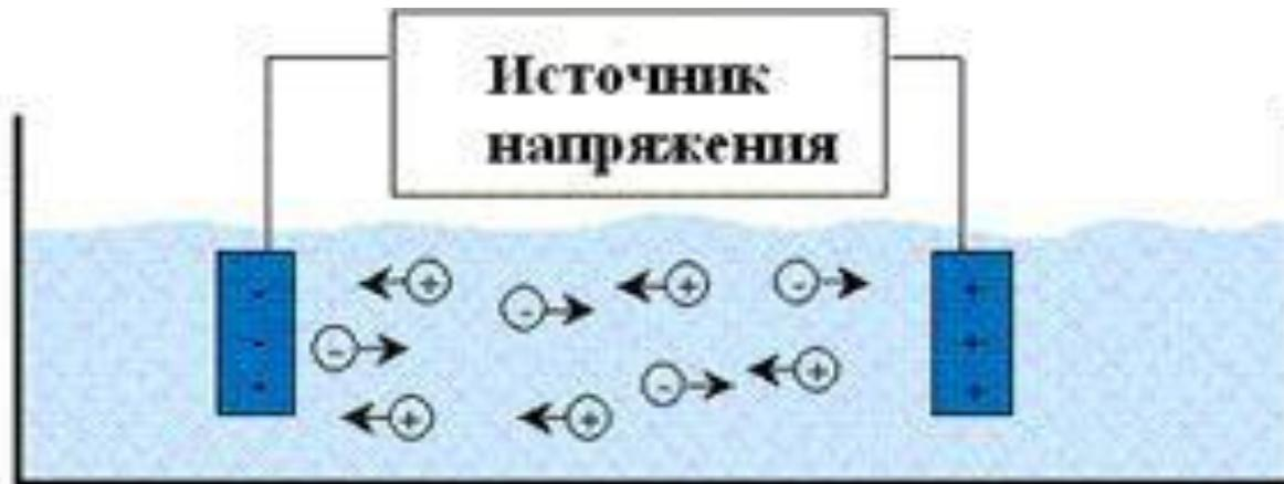
**В качестве измерительных приборов используют кондуктометры (измерение электропроводности) или мосты переменного тока (измерение сопротивления).**
