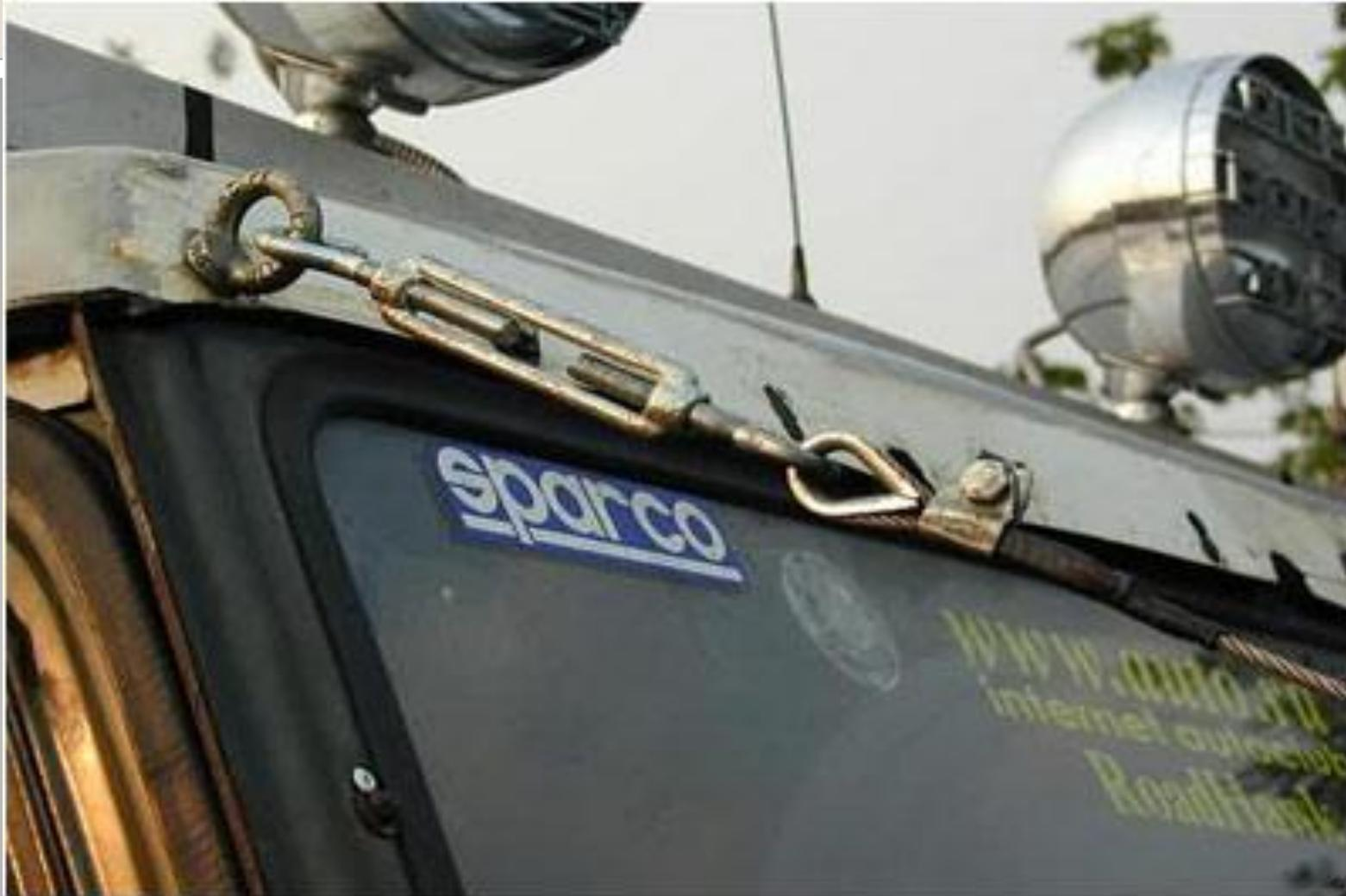
Рисунок – Крепление растяжки представляет собой натяжной механизм, подобие лебёдки
