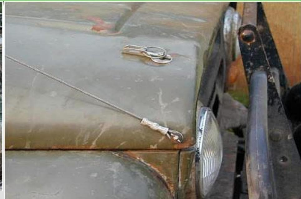
Рисунок– Можно закрепить растяжку к корпусу автомобиля, но лучше за рамки усилителя
