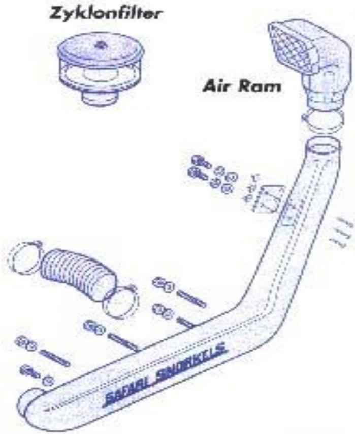
Он необходим не только когда капот машины погружается под воду. Иногда в двигатель может набраться вода и на малой глубине, достаточно поднять волну. А кроме того, неизвестно, какие ямы могут быть даже в самом мелком бросе. В большинстве случаев попадание воды в цилиндры работающего двигателя – фатально. Вода, как известно, в отличие от воздуха несжимаема, соответственно гнутся шатуны, ломаются коленчатые валы.
