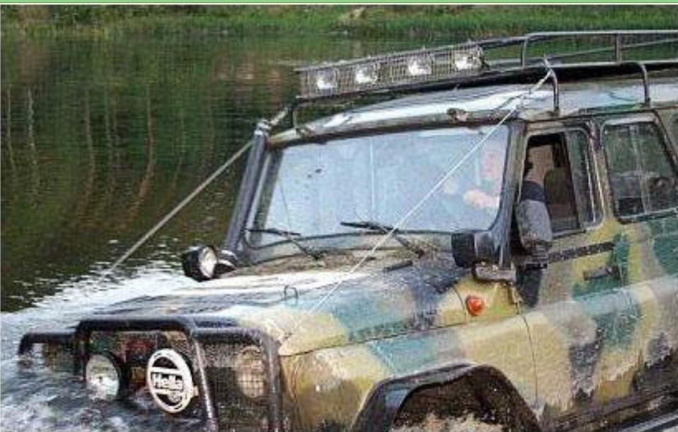
Рисунок – В данном случае растяжки крепятся за стойку багажника и за передние рамки усилителя
