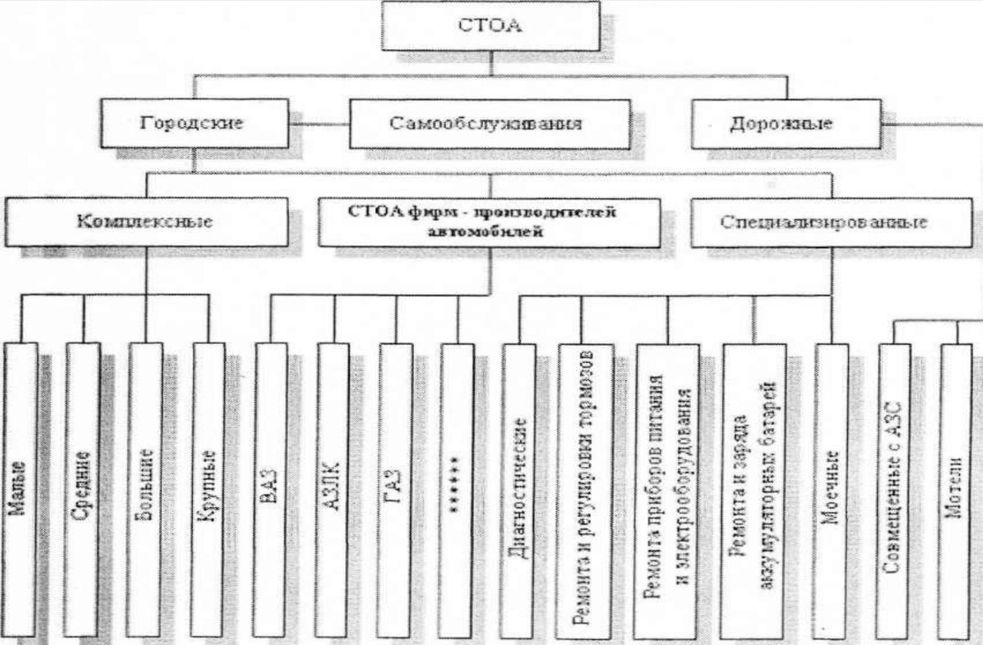
Рисунок – Классификация станций технического обслуживания автомобилей
