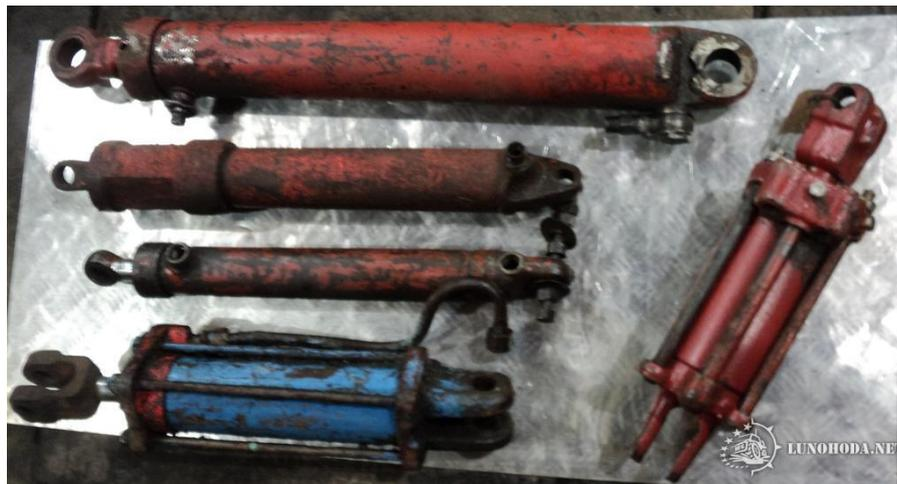
Номинальным параметром надежности ГЦ типа Ц является 90%-ный гамма-ресурс, равный 9000 мото-ч при использовании их в гидросистемах тракторов
