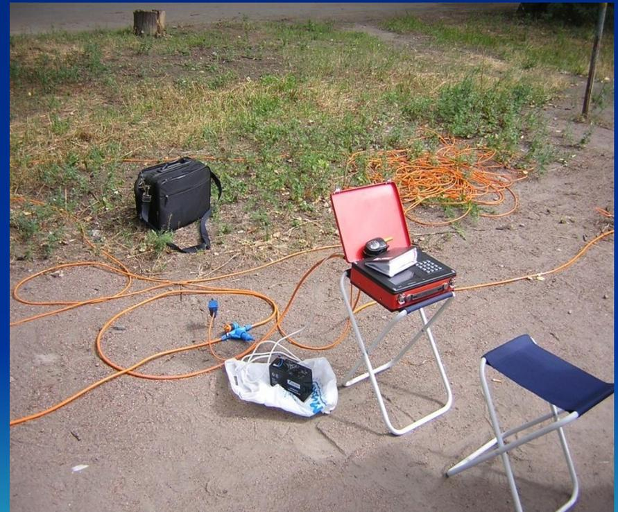
Современные сейсмические зонды (геофоны или акселерометры) позволяют фиксировать весь спектр упругих волн в грунтах, при этом могут быть отфильтрованы паразитические шумы, сняты эффекты смазывания, искажения и смещения фаз.
